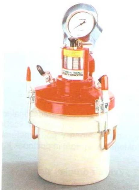
Slika 18: Manometer (Vir: SIST EN 12350-7:2001)
