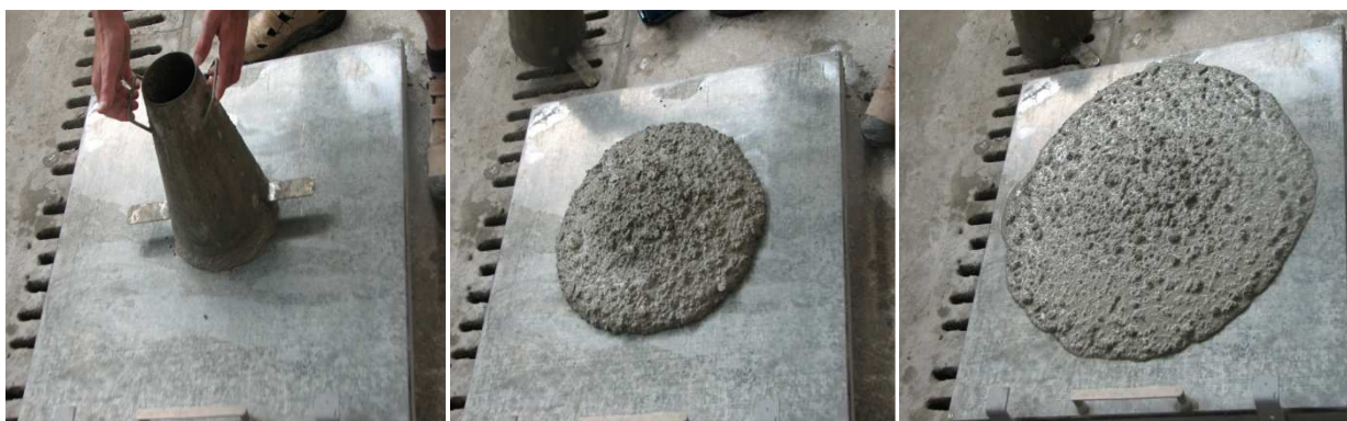
Slika 27: Iz leve proti desni si sledijo slike, ki prikazujejo potek razleza betonske mešanice med preiskavo razleza s posedom
