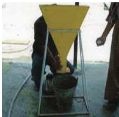
Slika 16: Na levi strani so prikazane dimenzije V-lijaka za preiskavo; na desni strani vidimo dejansko izvajanje metode z V-lijakom (Vir: http://theconstructor.org )
