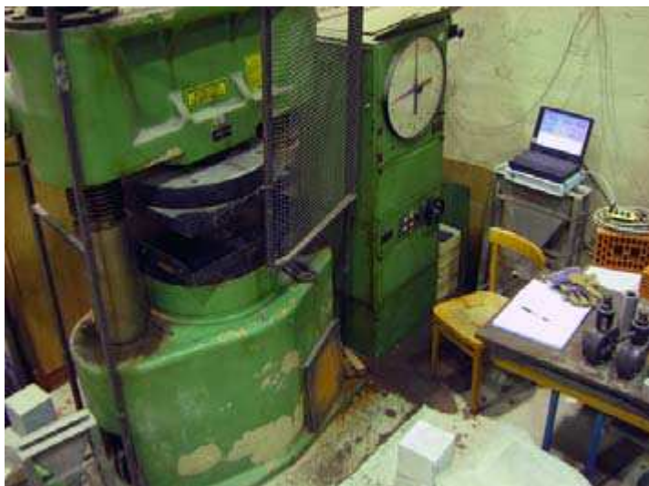
Slika 21: Tlačna preša z računalniškim zajemanjem podatkov (Vir: Duh, 2008)
