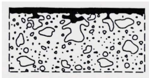
Slika 19: Preplastitev betonske površine s prevleko, ki ustvari neprepusten film
