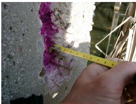
Slika 11: Fenolftaleinski test na izvrtanih valjih, kjer roza barva pomeni pH vrednost večjo od 9,2.
