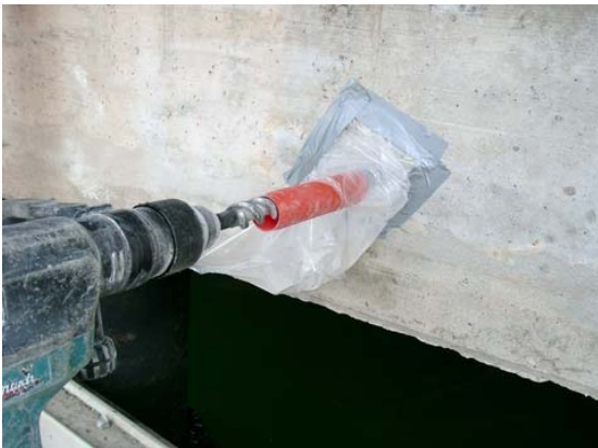
Slika 36: Odvzem vzorcev betona za določitev koncentracije kloridov
