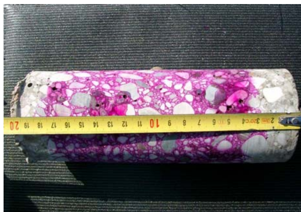
Slika 11: Fenolftaleinski test na izvrtanih valjih, kjer roza barva pomeni pH vrednost večjo od 9,2.
