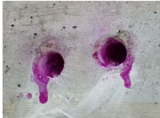
Slika 36: Odvzem vzorcev betona za določitev koncentracije kloridov
