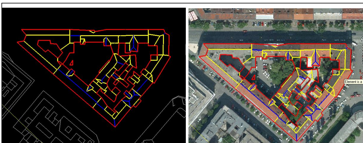
Slika 51: Avtomatsko vektorizirana streha stavbe
