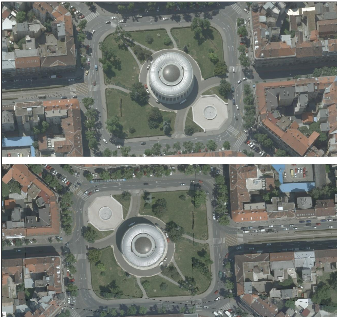
Slika 54: Primer izreza iz obravnavanega območja na aeroposnetku (zgoraj) in istega območja na ortorektificirani podobi (spodaj), pridobljeni na osnovi fotogrametričnega zajema
