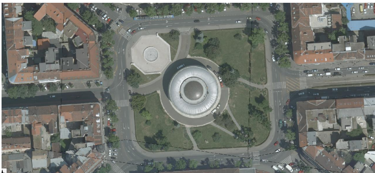
Slika 57: Primer izreza obravnavanega območja za primerjavo na ortorektificirani podobi, pridobljeni na osnovi lidarskih točk
