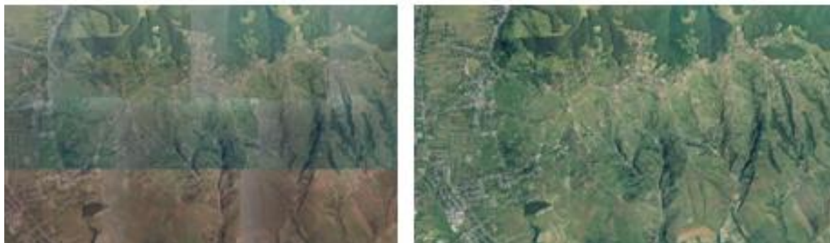
Slika 33: Vhodni posnetek (levo) in radiometrično popravljen posnetek (desno) (Gisbox)
