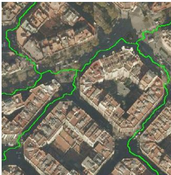
Slika 36: Optimalna stična linija (INPHO GmbH)
