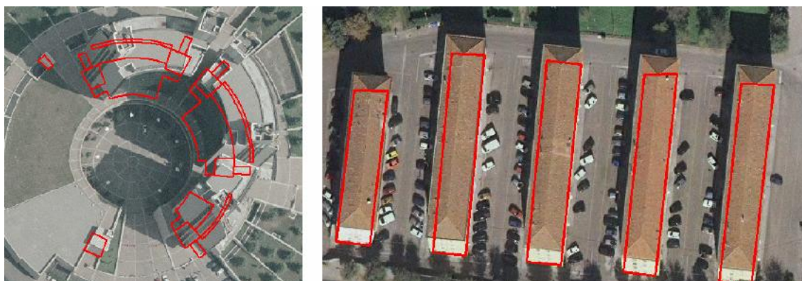
Slika 13: Ortofoto izdelan na osnovi digitalnega modela reliefa; objekti so premaknjeni z njihove prave pozicije (Barazzetti, Brovelli in Scaioni, 2007: 27)
