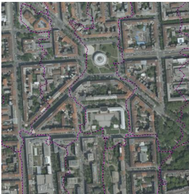
Slika 44: Avtomatsko poiskane stične linije med ortoposnetki
