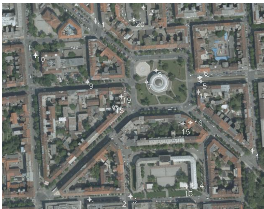
Slika 66: Detajlne točke, prikazane na popolnem ortofotu
