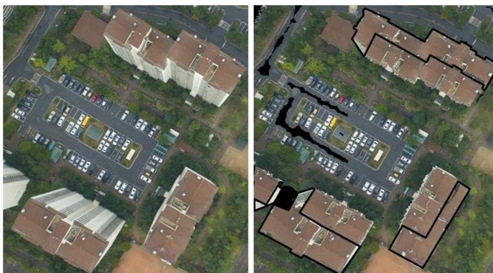
Slika 6: Aeroposnetek v centralni projekciji (levo) in iz njega izdelan ortofoto (desno), ki prikazuje označene posledice dvojnega kartiranja (Kim, Ghanma in Habib, 2006: 4)
