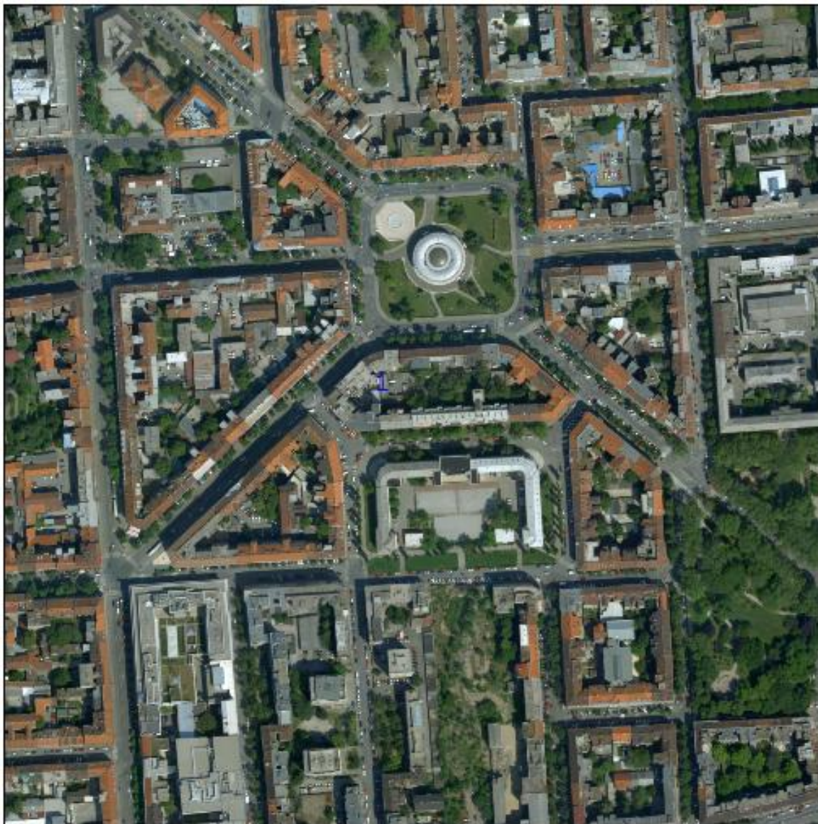
Slika 53: Popolni ortofoto, izdelan na osnovi fotogrametričnega zajema
