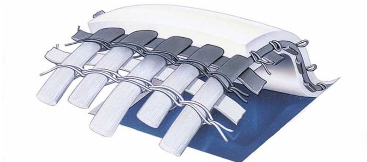
Slika 19: Membrana sestavljena iz osnovne tkanine, kjer so osnovne in votkove niti preje spletene skupaj z nitjo, prevlečene s polimerno prevleko.
