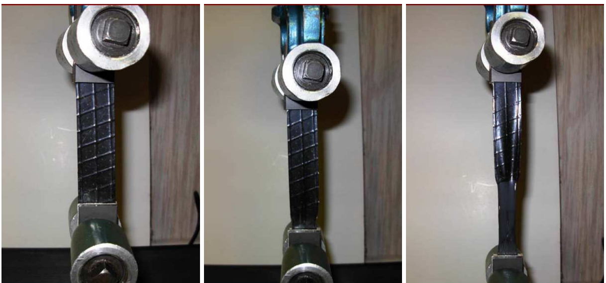
Slika 30: Obremenjevanje preizkušanca do porušitve pri metodi s tračnim preizkušancem s polnim vpetjem ob merjenju napetosti in raztezka.
