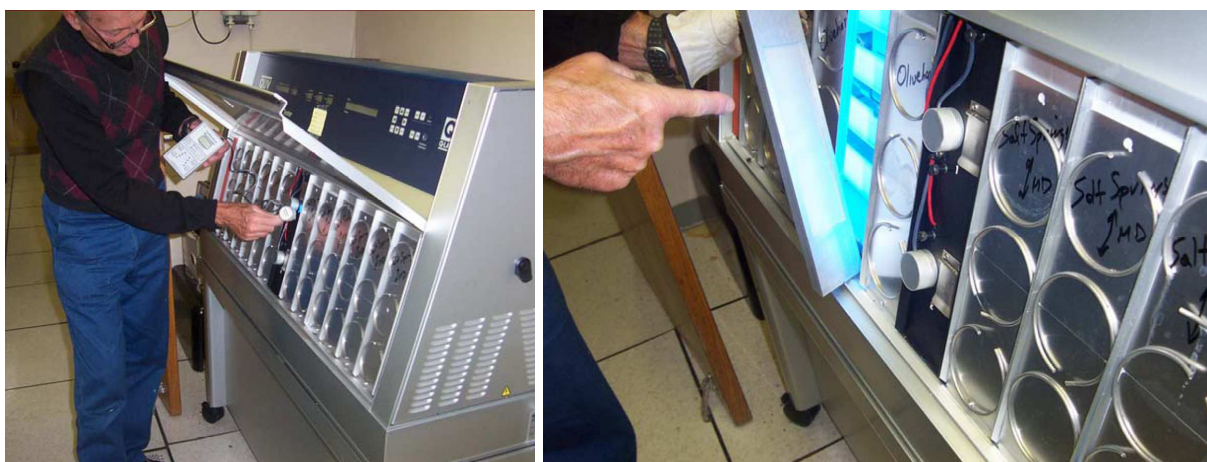
Slika 34: Laboratorijska oprema za pospešeno preperevanje oz. staranje membranskih vzorcev s simulacijo vremenskih vplivov in s fluorescentno UV svetlobo.
