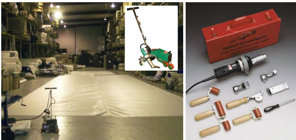
Slika 27: Ročno vodena varilna naprava (levo) prostoročna varilna naprava z različnimi nastavki in valjčki za varjenje z vročim zrakom (desno) .
