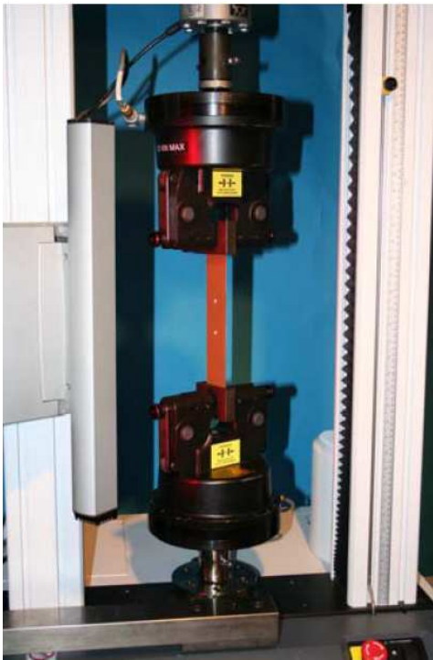
Slika 59: Hidravlična naprava z video merilcem deformacij med obremenjevanjem tračnega preizkušanca.
