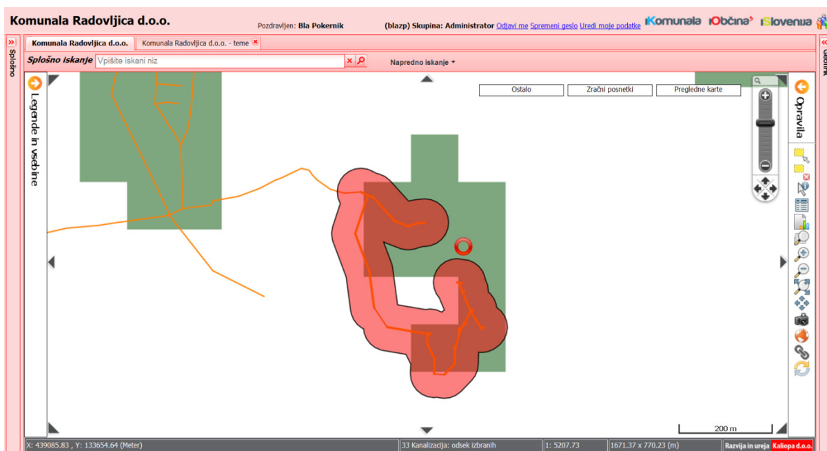
Slika 31: Določitev cone odmika - pasa okoli kanalizacijskega omrežja
