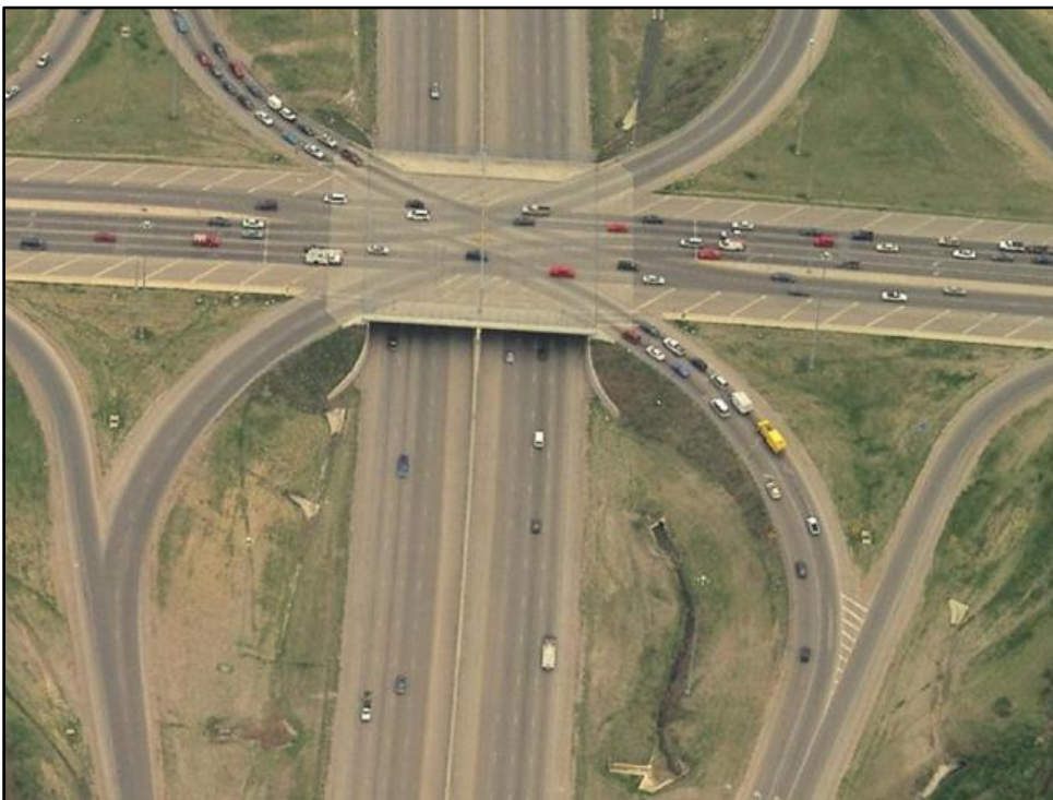
Slika 37: Druga možnost izvedbe SPUI križišča
