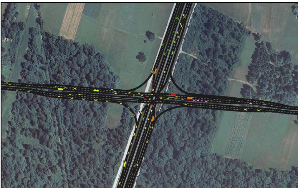
Slika 2: Mikroskopska simulacija po metodi dinamičnega obremenjevanja
