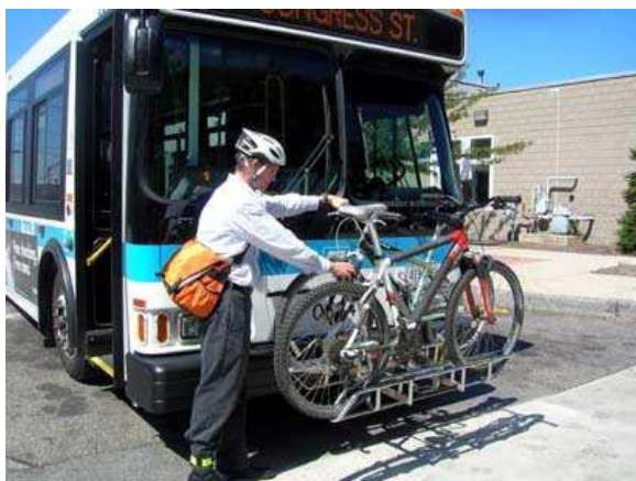
Slika 4.53: Primer nosilca za kolesa, ki je pritrjen na avtobus (Vir: Medmrežje 52)
