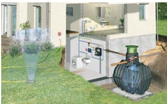
Slika 3.14: Shema sistem zbiralnika deževnice (Vir: Medmrežje 28)
