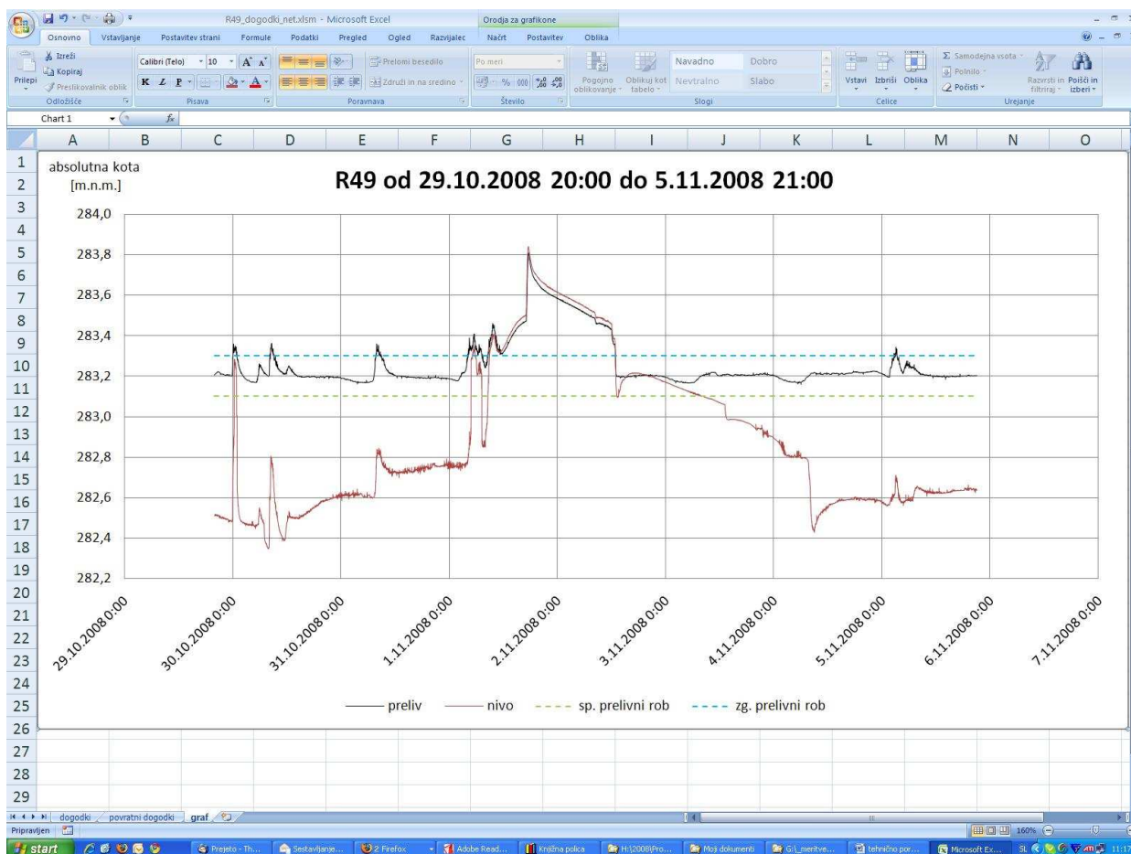
Slika 31: Prelivanje javne kanalizacije v reko Ljubljanico – meritve gladine reke in kanala ter količini prelite odpadne vode v v dotok, JP VO-KA, 2008
