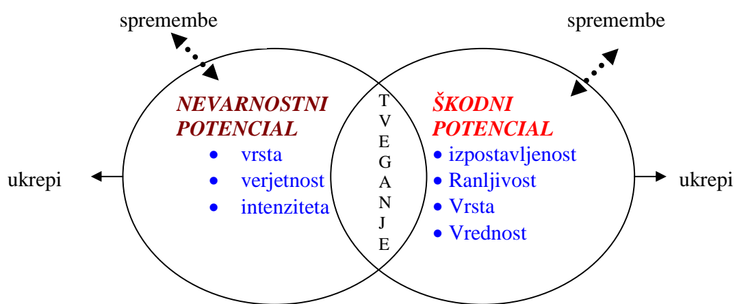
Slika 7: Parametri določitve tveganja (prirejeno po Đurovič & Mikoš, 2004)
