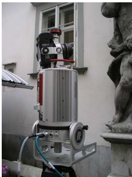
Slika 5.8: Laserski skener Riegl VZ-400 s fotoaparatom Nikon D700 pred Mislejevim portalom
