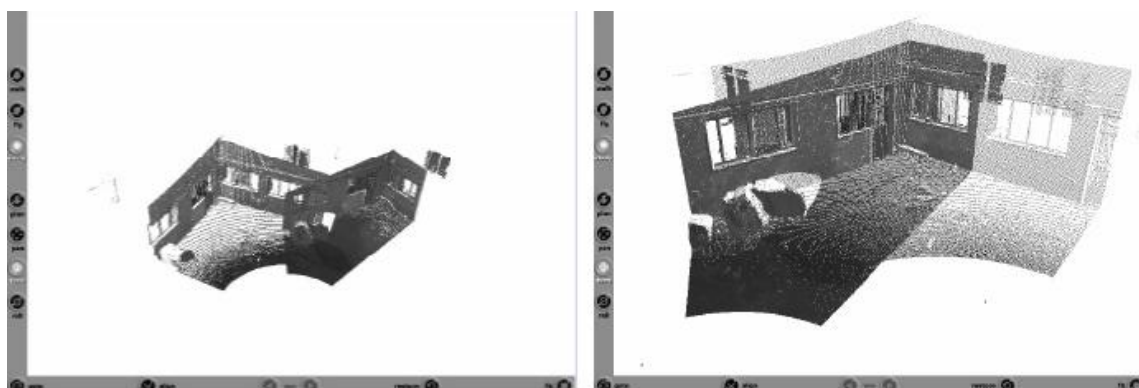
Slika 3.3: Dva oblaka točk (levo) sta združena preko postopka registracije (desno) (Sveučilište u Zagrebu, 2008)
