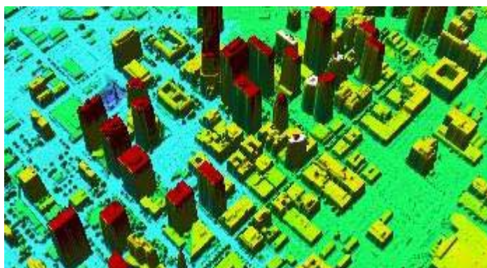
Slika 2.10: Laserski zajem objektov iz zraka v urbanem okolju – LIDAR (Leica Geosystems, 2009)
