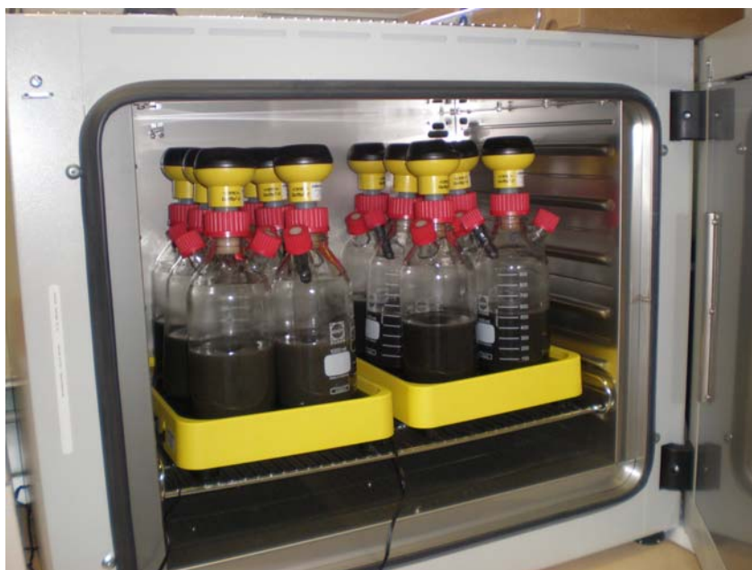
Slika 19: Začetek poskusa – steklenice, inkubirane v topli komori pri 37°C (9.10.2008)
