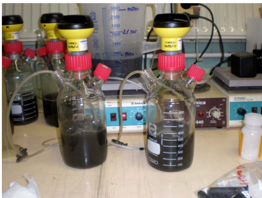
Slika 16: Prepihanje substrata s plinastim dušikom pred zaprtjem steklenic (9.10.2008)
