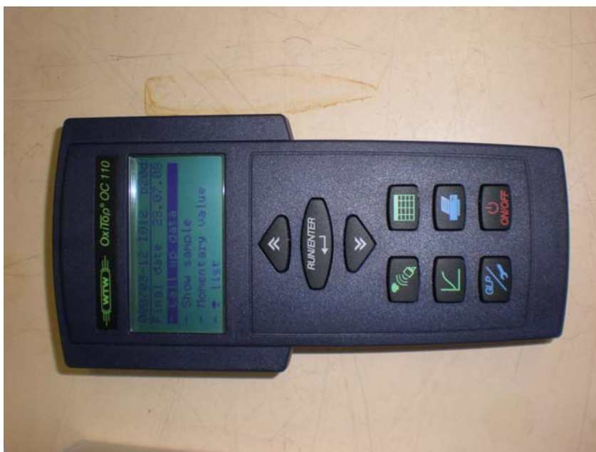
Slika 17: Aparat OxiTop® OC110 za nastavitev začetnih vrednosti v merilnih glavah ter prenos podatkov (9.10.2008)
