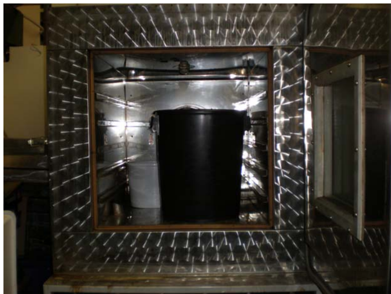
Slika 10: Notranjost termostatirane komore – večja posoda s substratom ter manjše vedro vode (9.5.2008)
