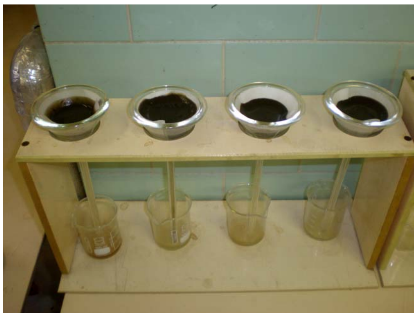
Slika 15: Določanje vsebnosti suhe snovi v vzorcu tekočega nepregnitega blata s CČN Radovljica (9.10.2008)
