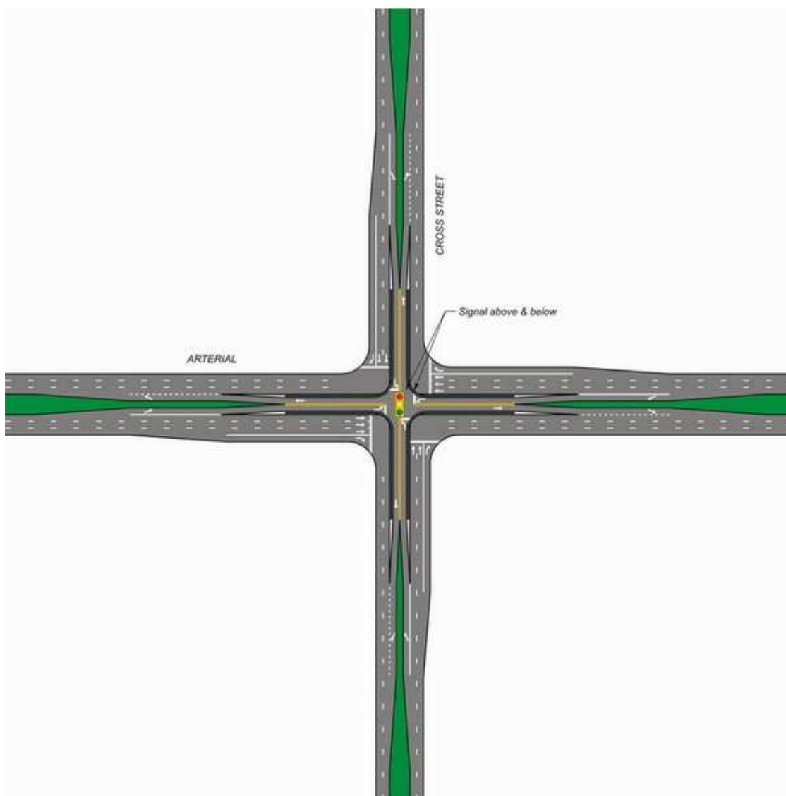
Slika 3.16 Semaforizirano križišče z levim zavijanjem preko sredinskega nadvoza (vir: http://attap.umd.edu/img/Designs/13.jpg )
