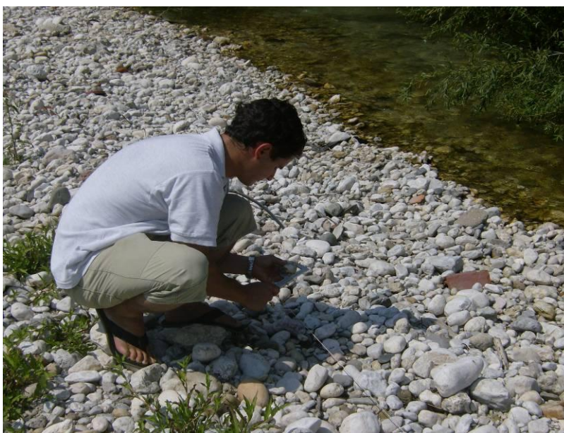
Slika 28: Meritev srednjega premera zrn pod vrvico pri linijski analizi prodišča (foto: Lunka, 1. 8. 2009)
