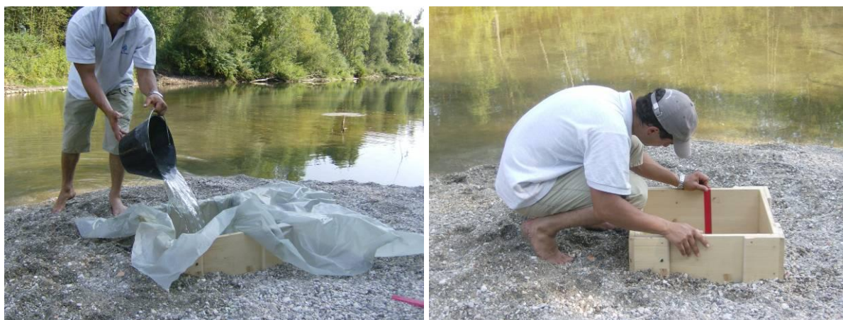
Slika 39: Polnjenje zakopanega škatlastega okvirja (levo) in meritev infiltracije (desno)
