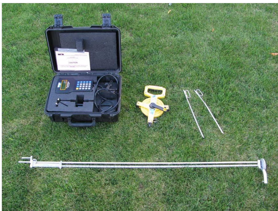
Slika 24: Za merjenje pretokov poleg merilnega instrumenta s sondo in stojalom potrebujemo tudi tračni meter in pritrdilna klina (foto: Bogataj, 20. 7. 2009)
