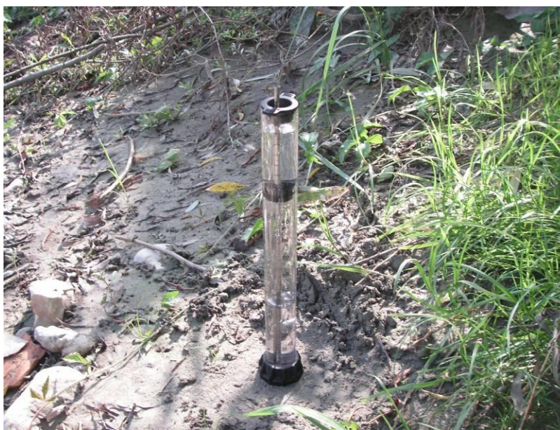
Slika 43: Meritev infiltracije z mini disk infiltrometrom v strugi Kamniške Bistrice ob desni brežini (foto: Bogataj, 3. 9. 2009)
