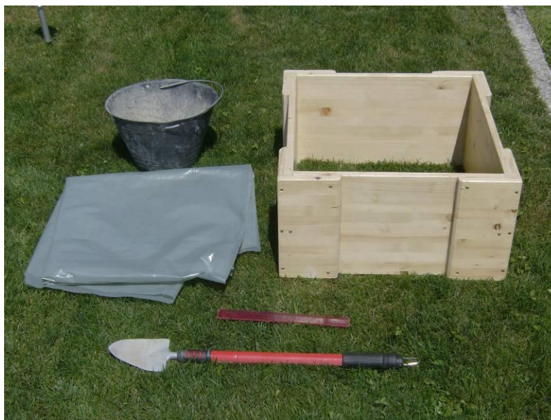
Slika 40: Oprema za merjenje infiltracije na prodiščih (foto: Bogataj, 2. 8. 2009)
