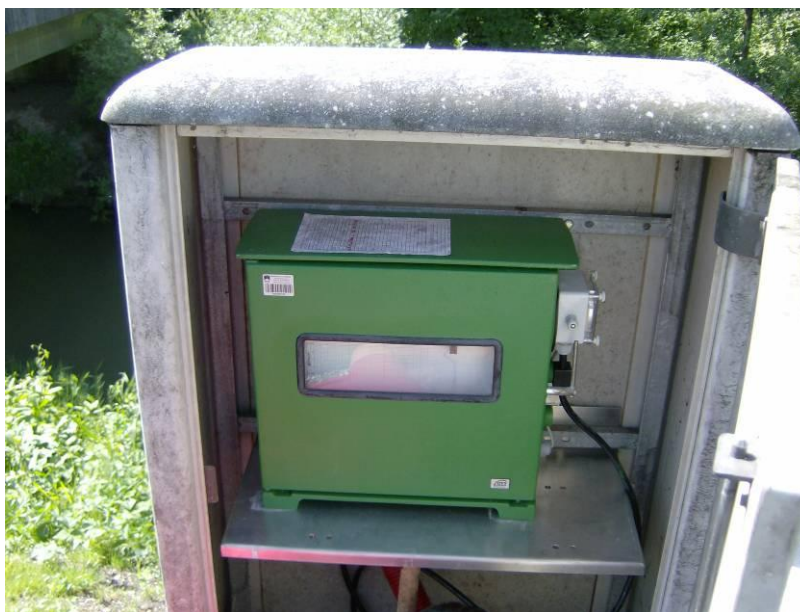
Slika 13: Limnigraf na vodomerni postaji Podrečje na Rači (foto: Bogataj, 28. 5. 2009)
