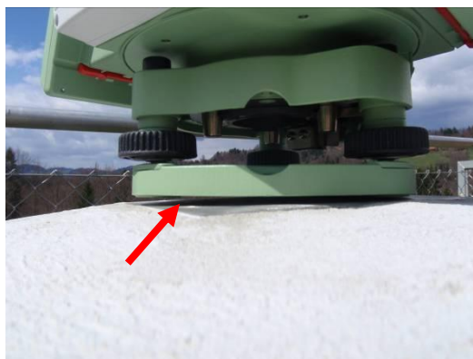
Slika 34: Nehorizontalnost kovinske plošče na vrhu stebra (nova stabilizacija opazovalnih točk - točka III-GPS) (Kogoj, Marjetič, Ambrožič, Stegenšek, Trlep, 2010).
