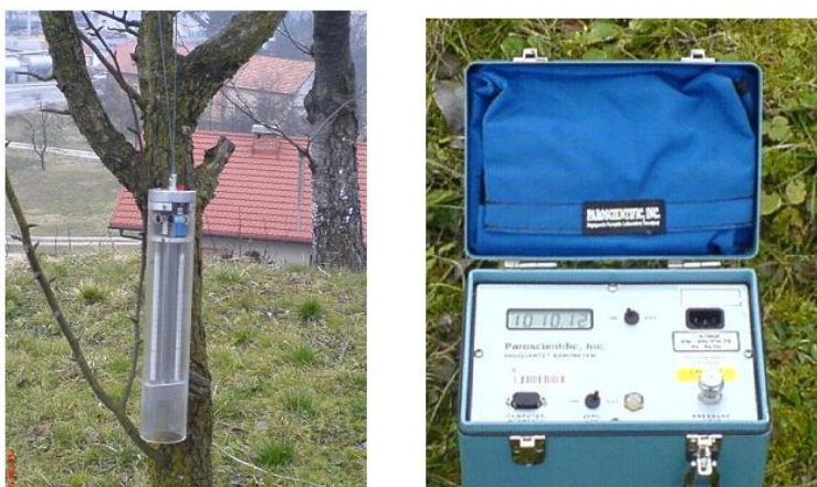
Slika 23: Precizni aspiracijski psihrometer in digitalni barometer (Šepetavc, 2008).
