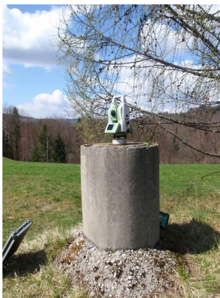
Slika 33: Stabilizacija opazovalne točke (točka 3) (Kogoj, Marjetič, Ambrožič, Stegenšek, Trlep, 2010).
