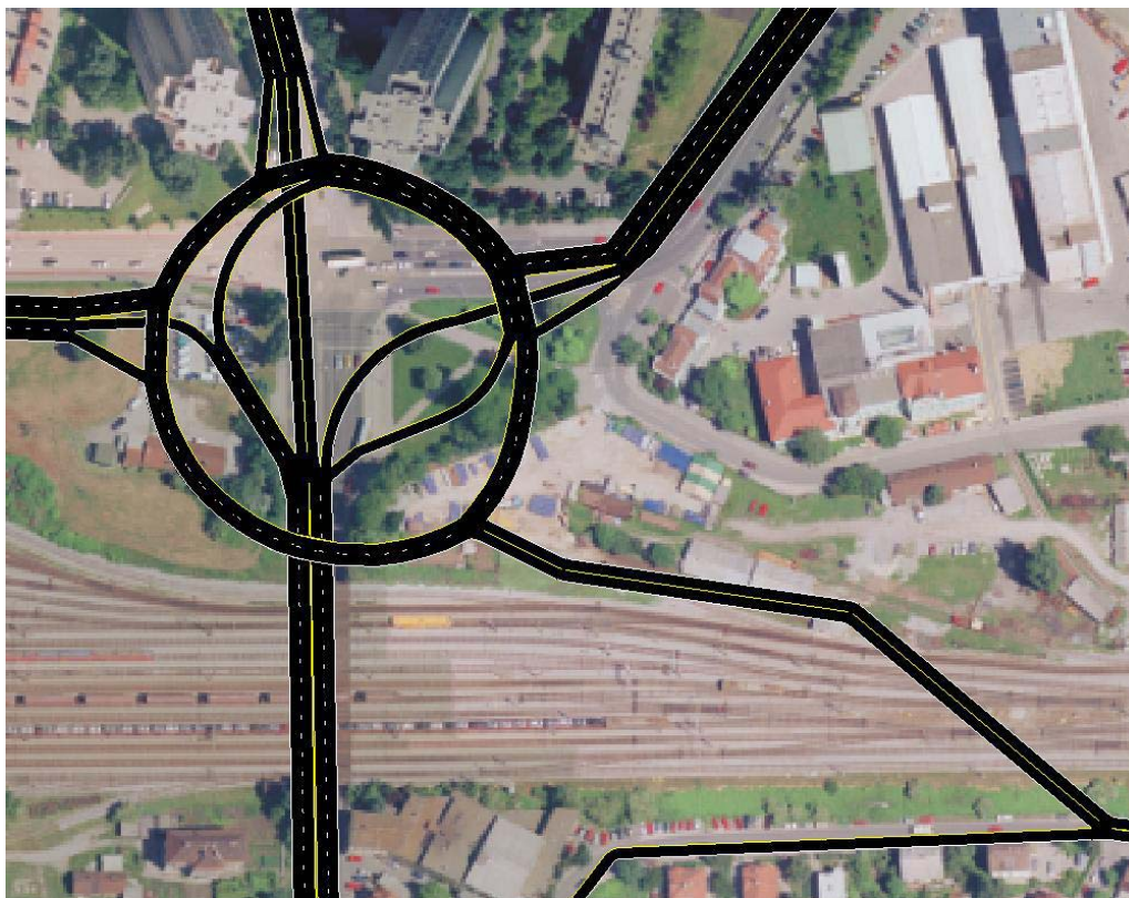
Slika 10: Geometrija krožnega križišča z vodeno smerjo v svojem nivoju
