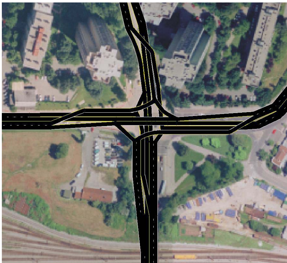
Slika 15: Geometrija dvonivojskega nesemaforiziranega križišča
