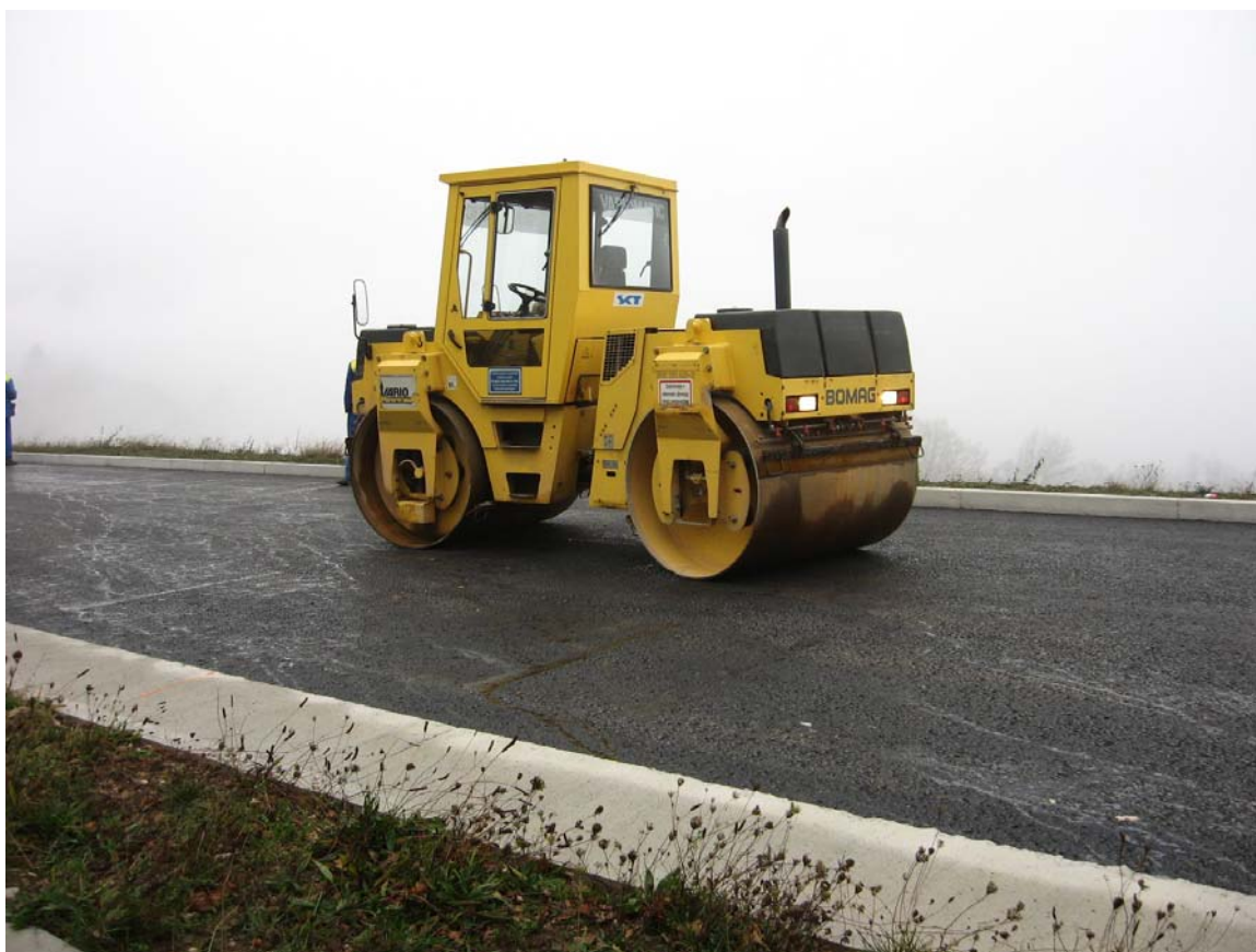
Slika 20: Ustavljanje valjarjev na še nezgoščeni bituminizirani zmesi
