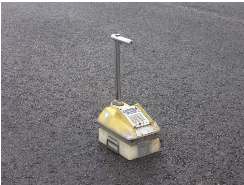
Slika 22: Izotopski merilnik tipa Troxler 34411 – B a21
