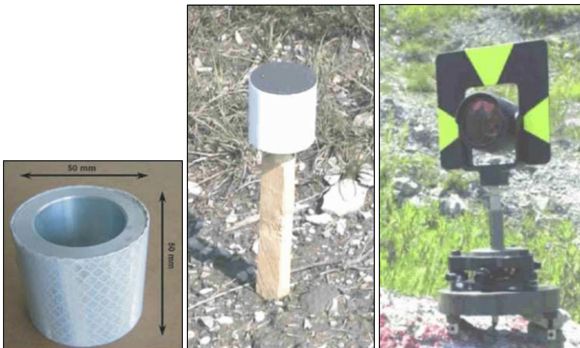
Slika 16: Refleksijska cilindrična tarča in prizma za 3D lasersko skeniranje (Riegl measurement systems – spletna stran, 15.01.2007)
