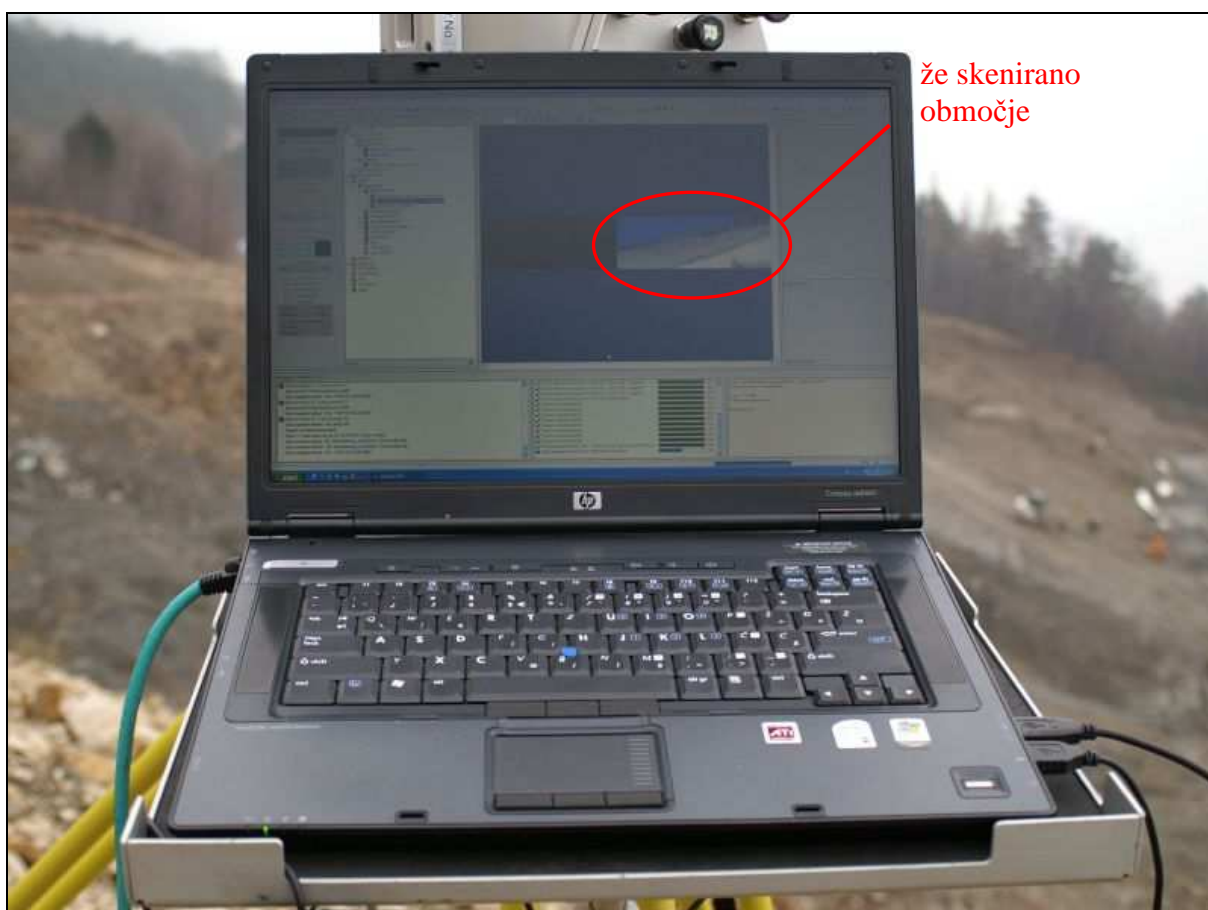
Slika 26: Spremljanje poteka skeniranja na prenosnem računalniku
