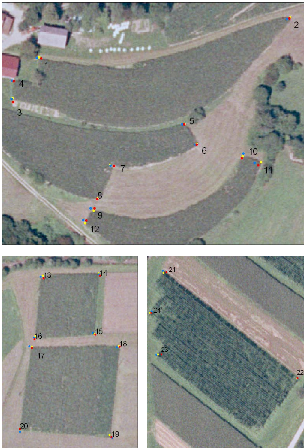
Slika 24: Primerjava zajetih točk (točke s posnetka 7410 so modre, s posneta 7411 rdeče in z ortofota rumene).
