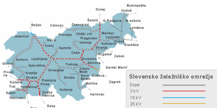
Slika 22: Shema elektrificiranih železniških prog v RS (Elektroenergetika, 5.6.2009).
