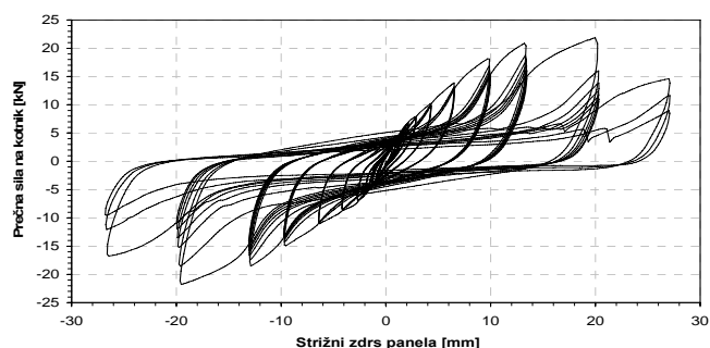
Slika 4.7: Rezultati strižne preiskave sidra in uporaba le-teh v programu SAP2000.
