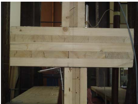
Slika 3.5: Preizkus W9s_C_V1_2, porušitev metetažnega stika z žebli dolžine 4 cm.
