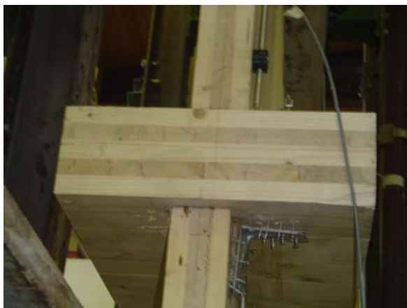
Slika 3.6: Preizkus W9s_C_V1_1, porušitev metetažnega stika z žebli dolžine 6 cm.
