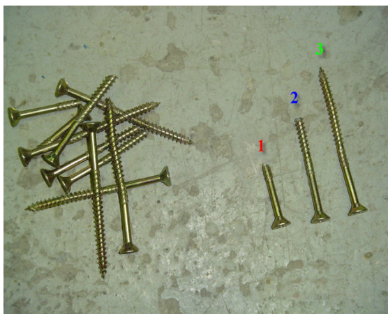
Slika 3.9: Preizkus W6c_C_V1_2, porušitev nekaterih vijakov v preklopnem stiku.
