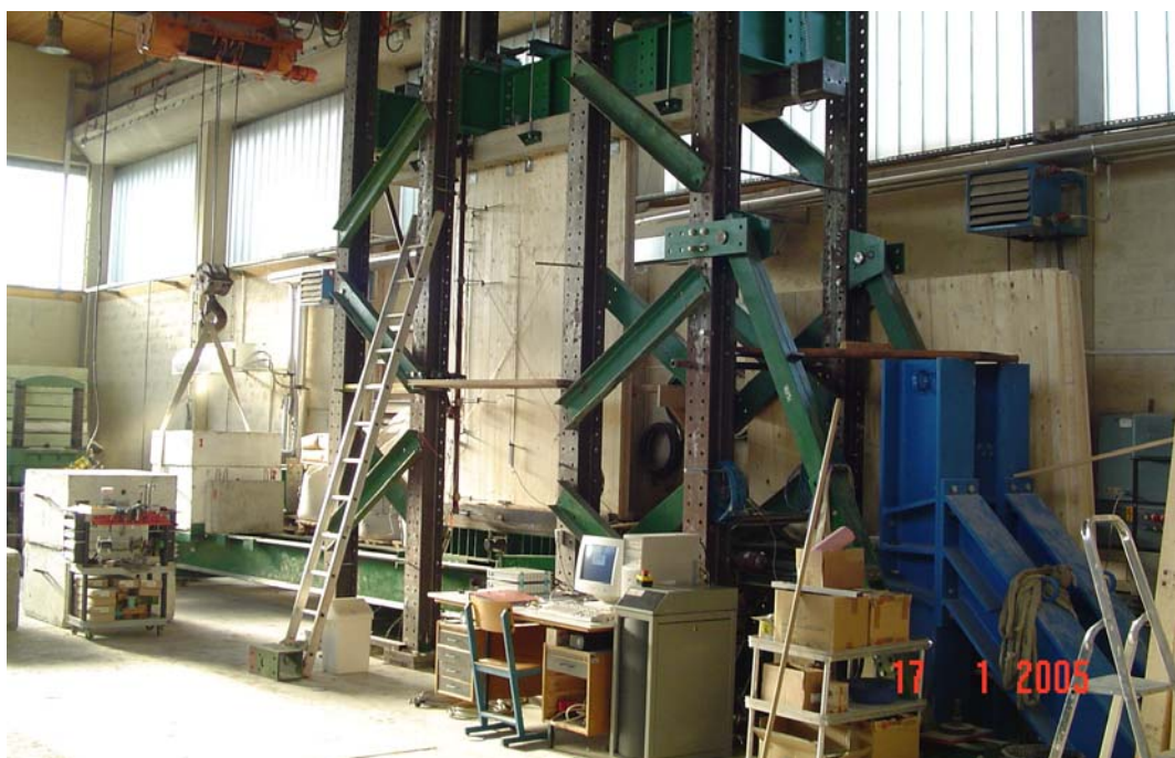
Slika 3.2: Naprava za preizkušanje strižne nosilnosti stenskih elementov.
