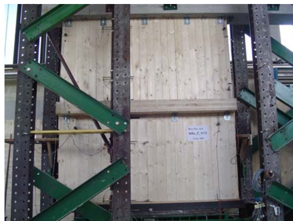
Slika 3.4: Preizkus obnašanja medetažnega sklopa z vmesno medetažno ploščo.
