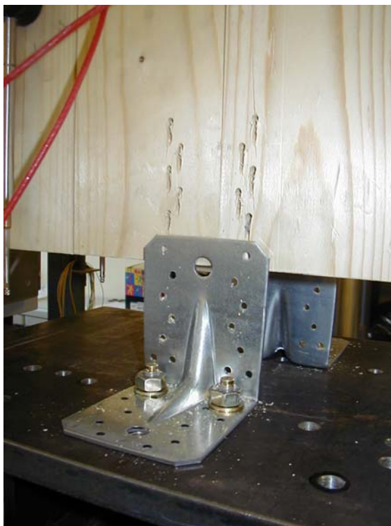
Slika 4.3: Porušitev kotnika po dvižni preiskavi.
