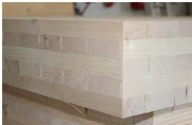
Slika 1: Tipičen prerez križno lepljene plošče
