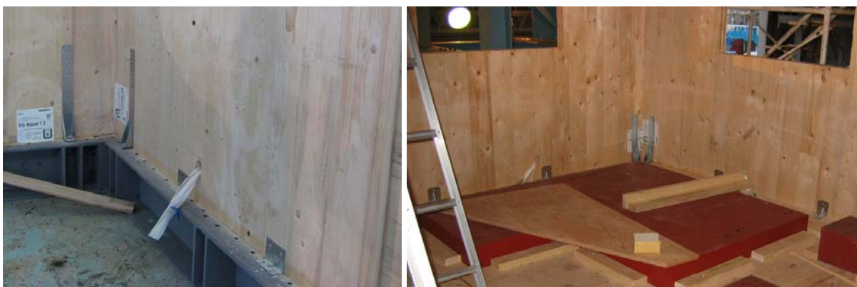
Slika 19: Dvižna in strižna sidra v pritličju (levo) in v etaži (desno) 3-etažnega preizkušanca na potresni mizi
