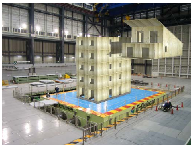
Slika 27: Sestava preizkušane konstrukcije na potresni mizi
