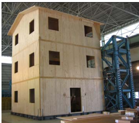
Slika 16: 3-etažna stavba iz križno lepljenega lesa na potresni mizi NIED v Tsukubi
