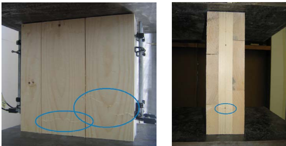
Slika 9: Porušitev preizkušanca obremenjenega vzporedno in pravokotno na smer vlaken zunanjih plasti (Klobčar, 2005)
