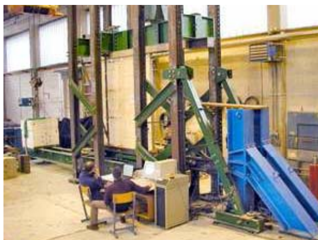
Slika 12: Preiskava za izvajanje cikličnih strižnih preiskav stenskih panelov
