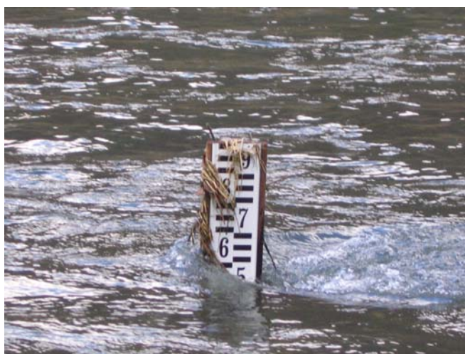
Slika 51: Vodomer predstavlja oviro toku vode
