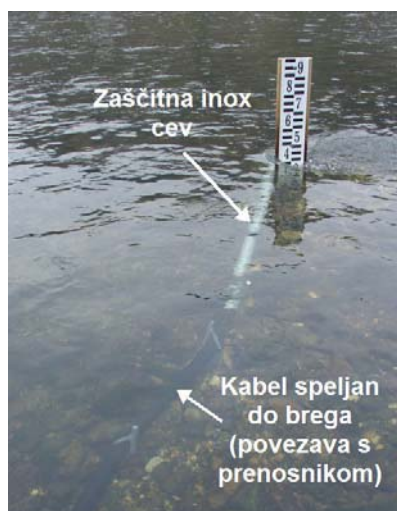
Slika 34: Namestitev zapisovalnika
