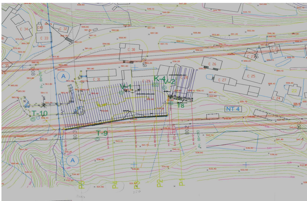
SLIKA 9: Prikaz dodatnih raziskovalnih vrtin na območju gostišča Trojane, izvedene leta 03
