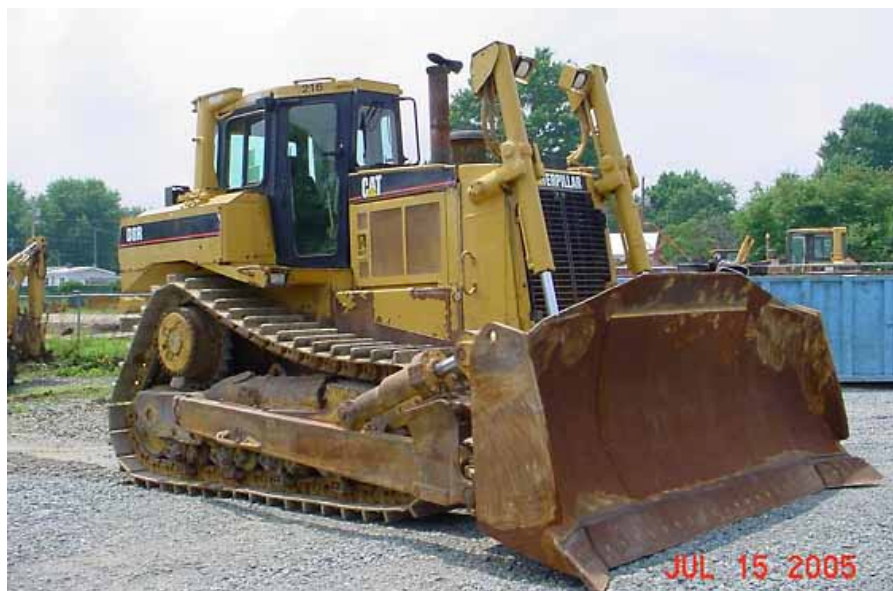
SLIKA 10: Primer dozerja za odpir materiala
