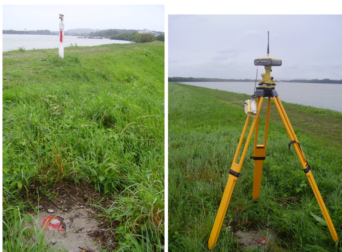
Slika 25: Prikaz označitve in postavitve instrumenta na trigonometru 40231_Z2
