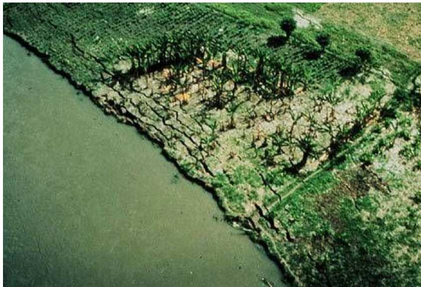
Slika 12: Potres magnitude 7,5 po Richterju v Gvatemali leta 1976 (Olson, 1977). Vidne so razpoke vzporedno z reko
