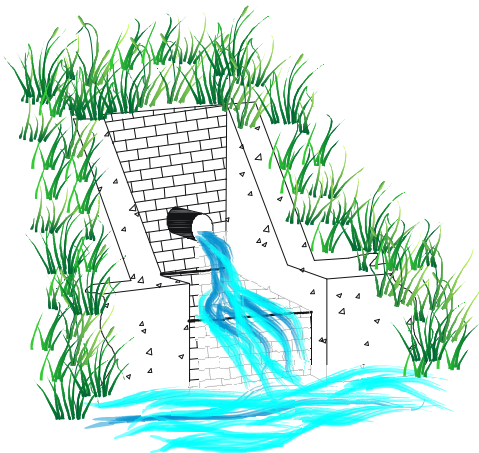
Slika 15: Iztok meteorne kanalizacije
