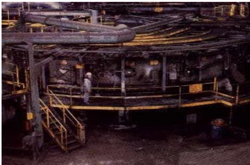
Slika 20: Rotacijska talilna peč
