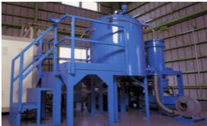
Slika 22: Vakuumska toplotna reciklažna enota TERA
