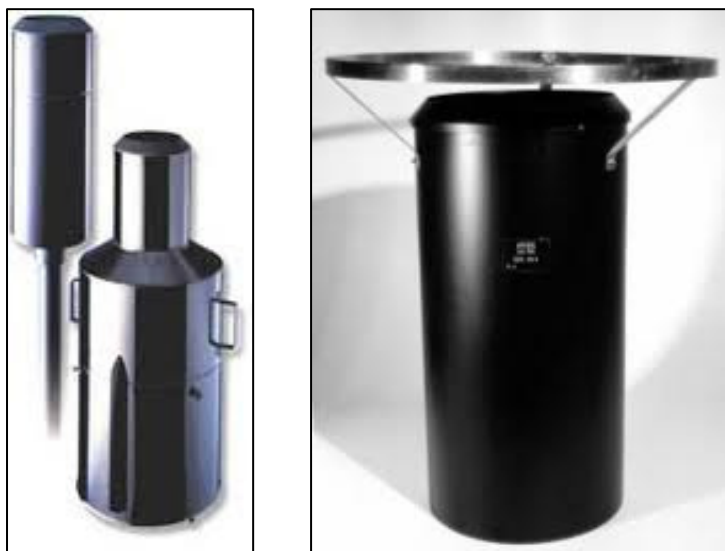
Slika 38: OTT Pluvio (levo) in AMES DDE 93A (desno), (CGS plus in AMES, 2010)
