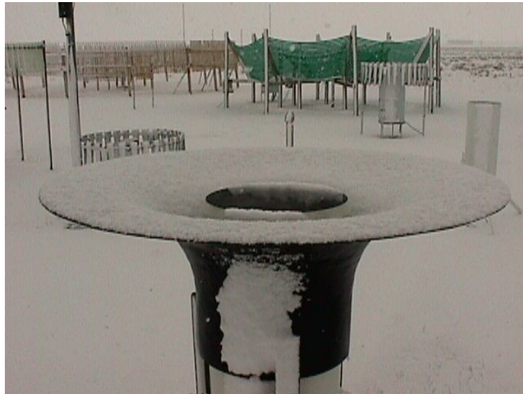
Slika 12: Nipherjev zaščitni obroč (National center for atmospheric research, 2008)
