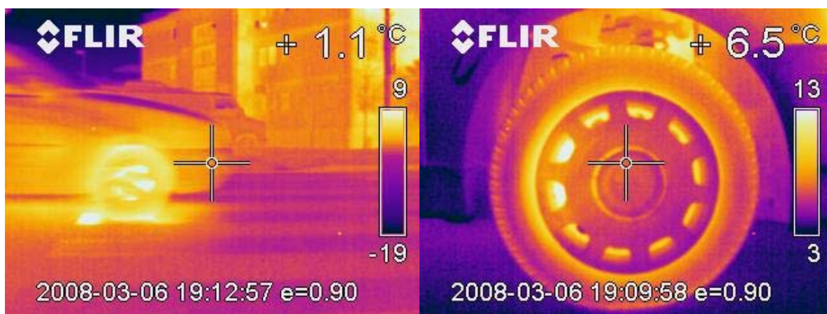
Zaznavanje pregetosti zavor s pomočjo infrared termalne kamere (FLIR)
