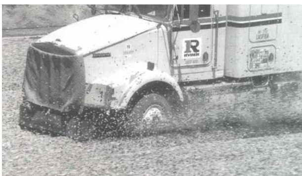
Vgrezanje vozila v drobnni prod (onlinepubs.trb.org)
