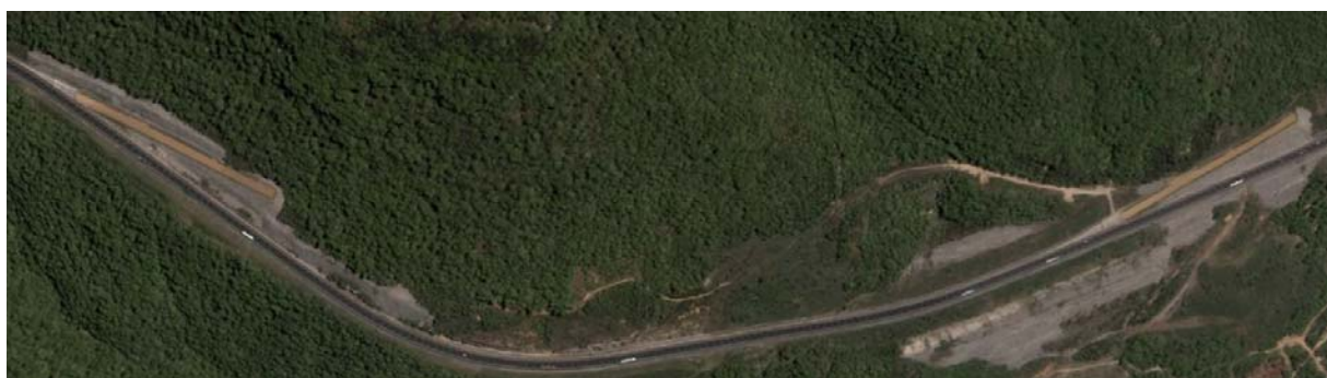
Zaporedna zasilna izvoza na razdalji 1,9 km s povprečnim nagibom -8,6 %, Monteagle mountain, I24, ZDA (Google Earth)
