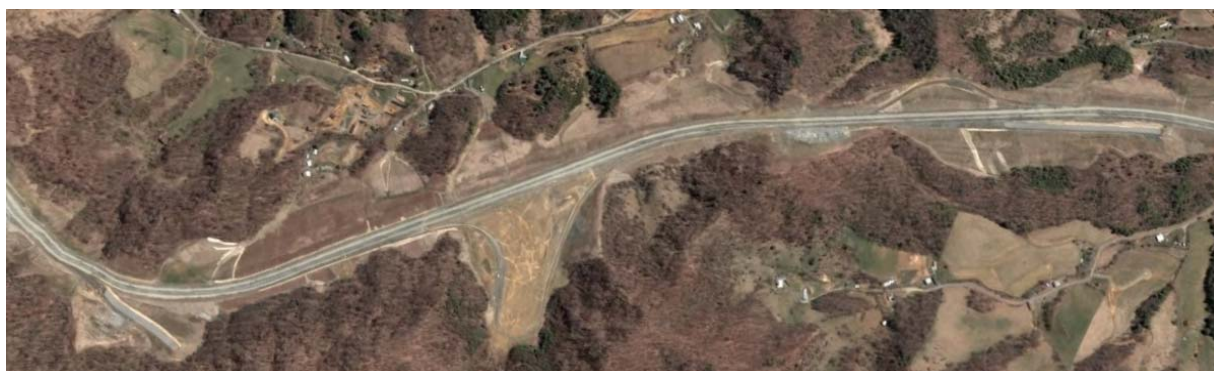
Zaporedna zasilna izvoza na razdalji 2,7 km, s povprečnim vzdolžnim nagibom -6 %, Wolf Laurel, I26, ZDA (Google Earth)
