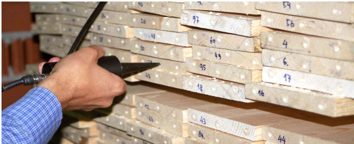
Slika 3.8: Merjenje z ultrazvočno napravo Sylvatest
