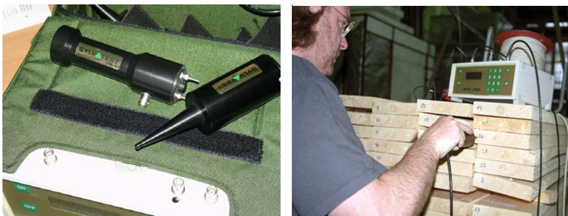
Slika 3.7: Ultrazvočna naprava Sylvatest
