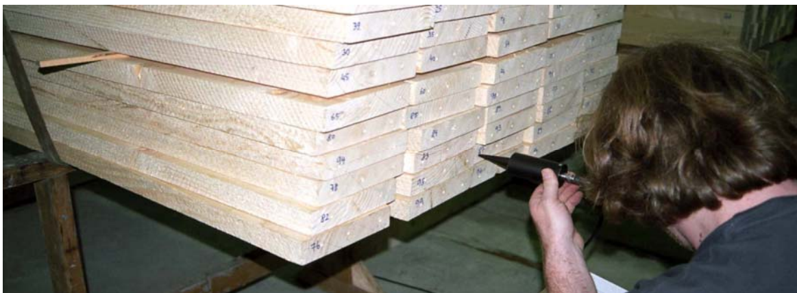
Slika 3.5: Merjenje z ultrazvočno napravo Sylvatest
