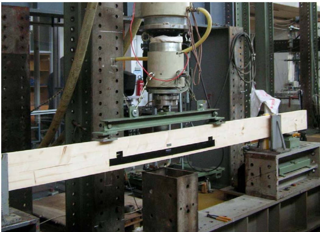
Slika B.5: Postavitev pokončnega upogibnega preizkusa (plohi)
