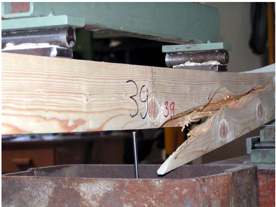
Slika B.4: Porušitev trama (ugotavljanje trdnosti)
