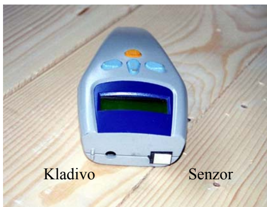
Slika 3.3: Timber Grader MTG
