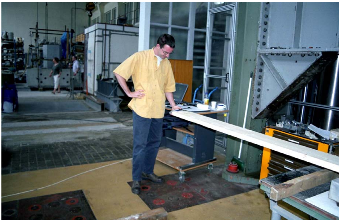
Slika B.2: Merjenje z napravo Timber Grader MTG
