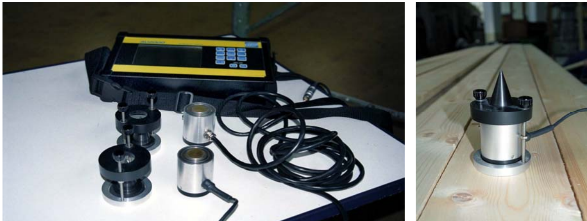
Slika 3.6: Ultrazvočna naprava AU2000 Ultrasonic tester, CEBPT
