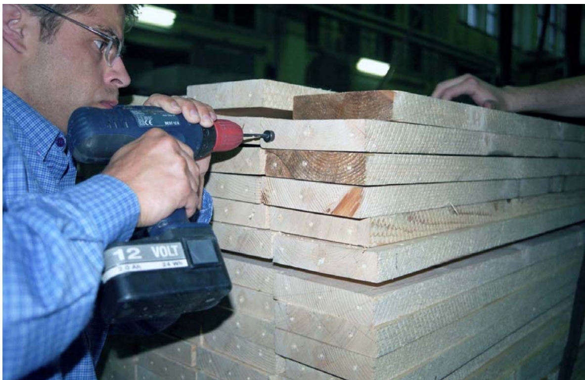
Slika B.1: Priprava - vrtanje lukenj za meritev z ultrazvočno napravo Sylvatest
