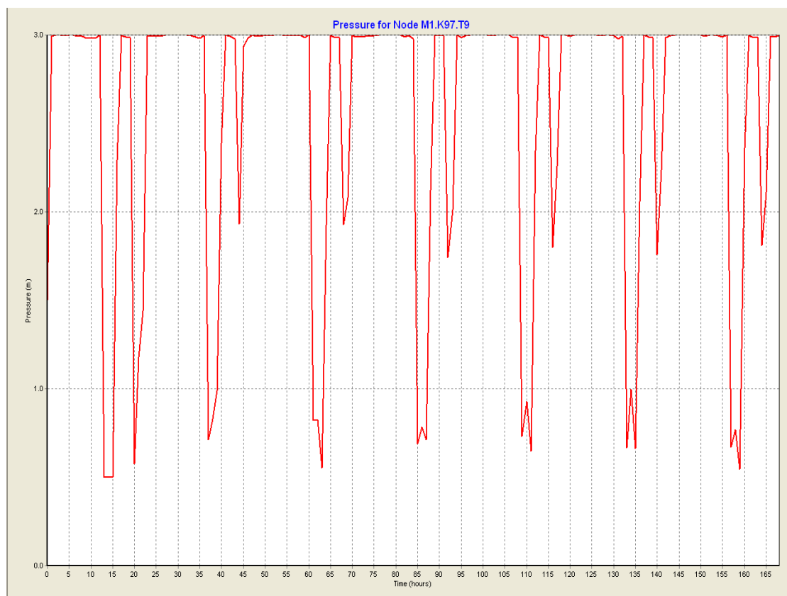
Slika 34: Nihanje gladine vode v vodohranu Grad 100 m 3 po zamenjavi cevi, Q_{max,d} , var. 3, podv. 2, čas simulacije 168 ur
