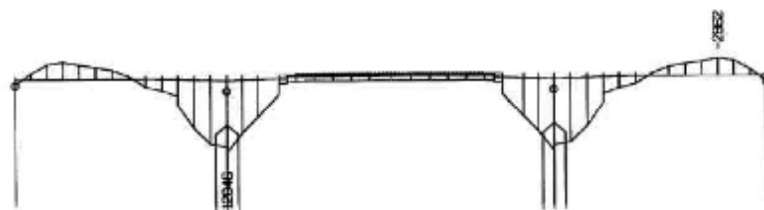
Slika 28b: Momenti M_y (kNm): kablov – faza 1 (Vir: Ponting, 2007, 29 str.)
