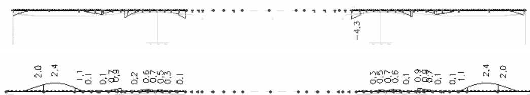
Slika 32: Napetosti na spodnjem robu (MPa): MSU - karakteristična
