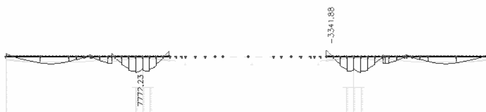
Slika 30: Momenti M_y (kNm): MSU - karakteristična
