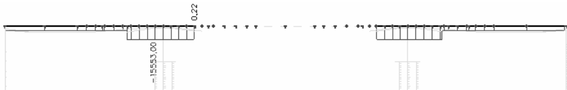
Slika 27: Osne sile N (kN): kablov – faza 1
