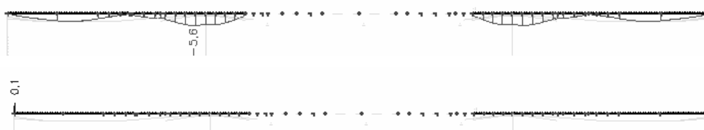
Slika 31: Napetosti na zgornjem robu (MPa): MSU - karakteristična
