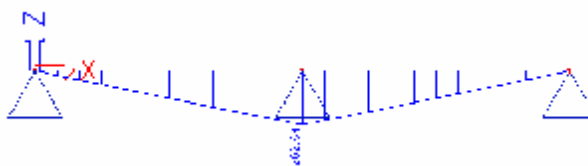
Slika A7: Notranje sile ( M_y ): F2-MAX
