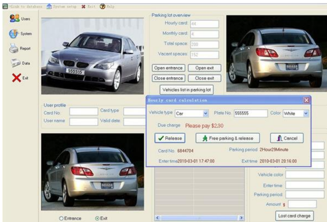
Slika: Kontrola dostopa preko prepoznavanja registerskih tablic
