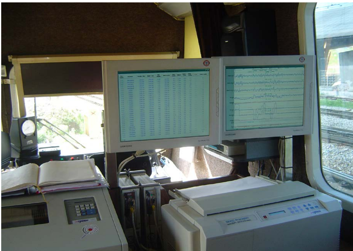
Slika 13: Računalniški in papirni grafikonski zapis merjenih parametrov drezine FMK 004.
