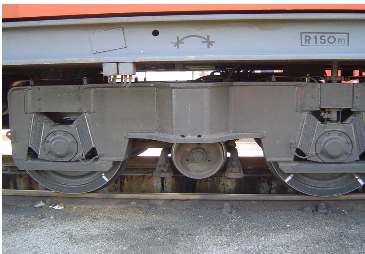
Slika 14: Mehansko merilno kolo merilne drezine FMK 004.
