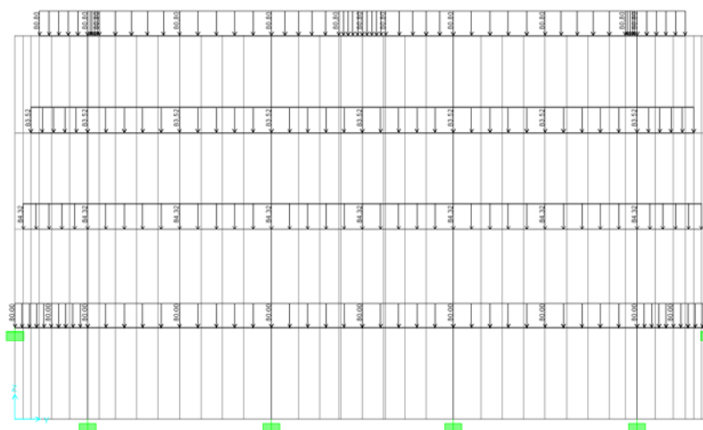
Slika 2.14: Primer prikaza lastne teže in stalne obtežbe v programu SAP 2000
