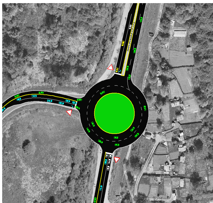
Slika 15: Geometrija krožnega križišča
