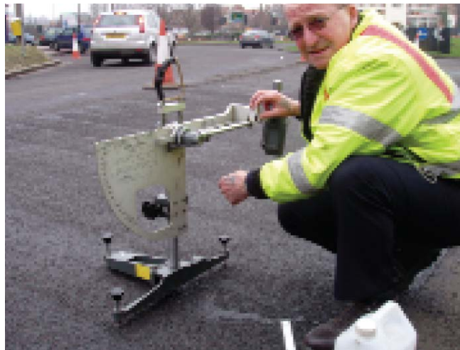
Slika 34: Merilni inštrument za merjenje SRT
