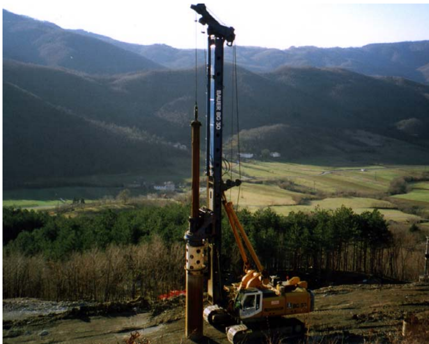
Slika 17: Vrtalna garnitura za izdelavo pilotov
