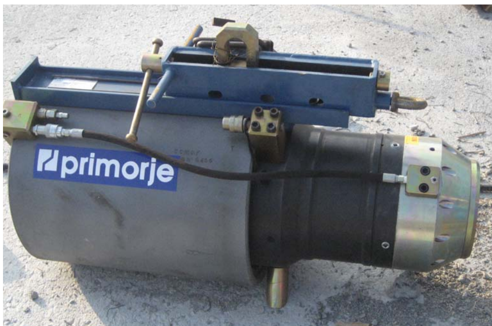
Slika 96: Hidravlični cilinder za napenjanje kablov
