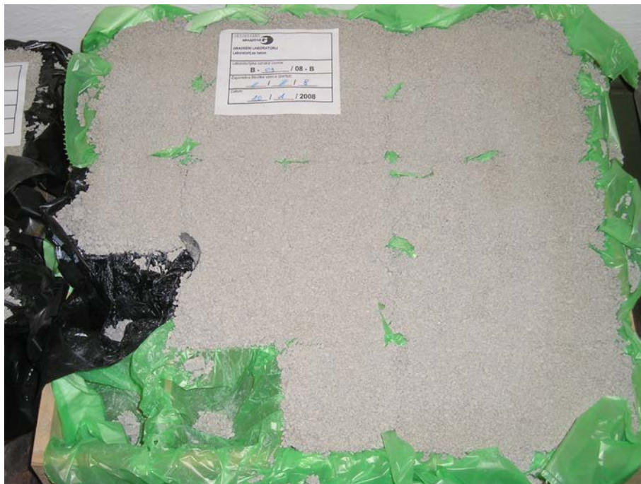
Slika 3.5: Odvzem vzorca za CM metodo iz lesenega kalupa
