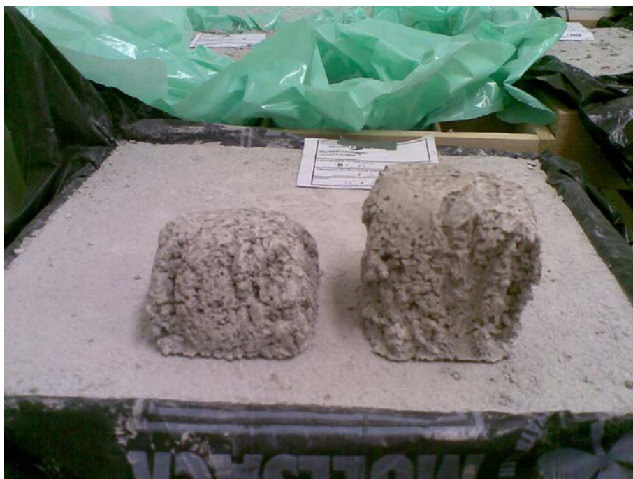
Slika 3.6: Odvzeti vzorci iz lesenega kalupa za preiskavo
