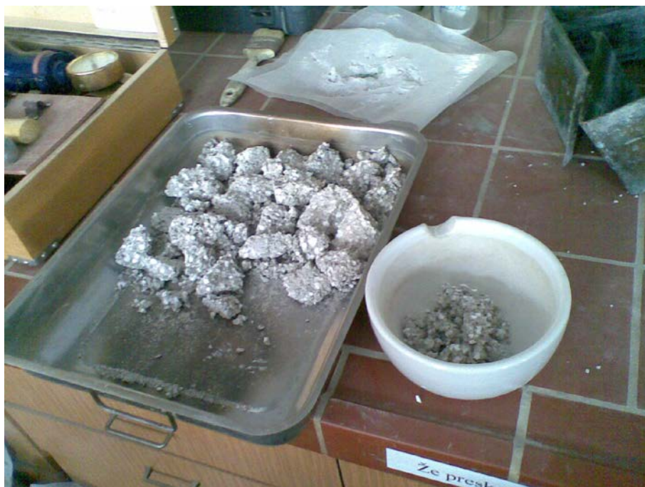
Slika 3.7: Odvzem vzorca za pripravo v možnarju
