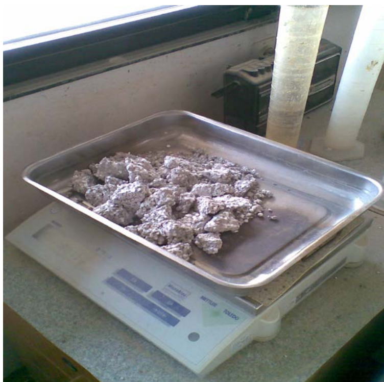
Slika 3.12: Tehtanje vlažnega vzorca
