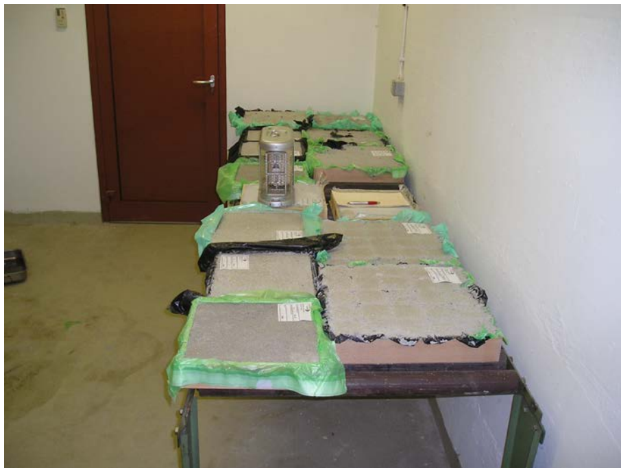
Slika 3.4: Hranjenje vzorcev v laboratoriju
