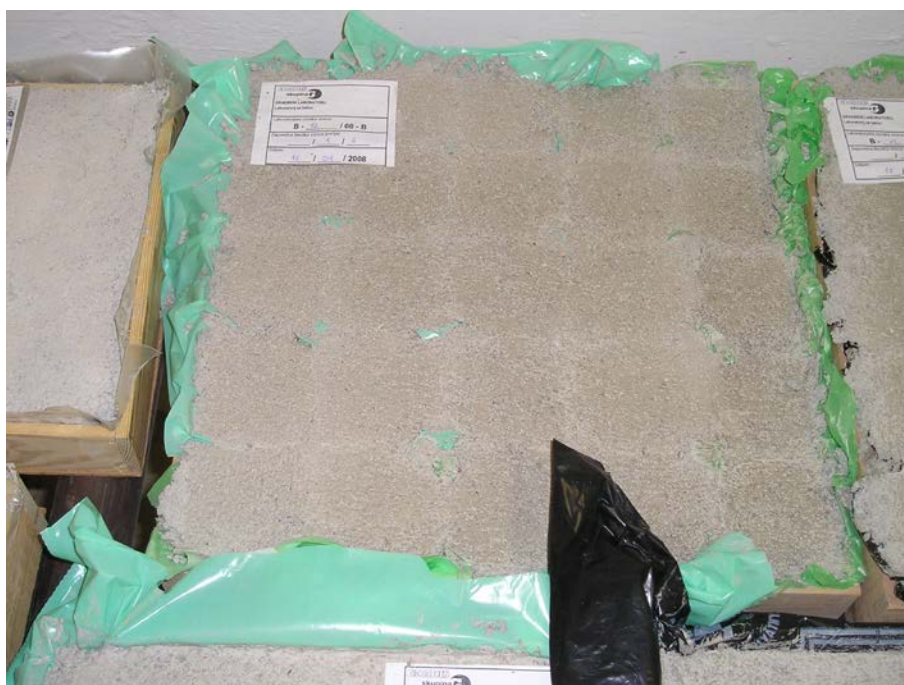
Slika 3.3: Estrih vgrajen v leseno škatlo/kalup s pregradami
