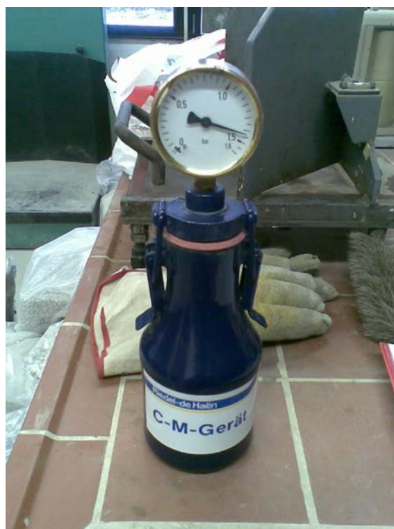
Slika 3.10: Meritev vlage s CM aparatom
