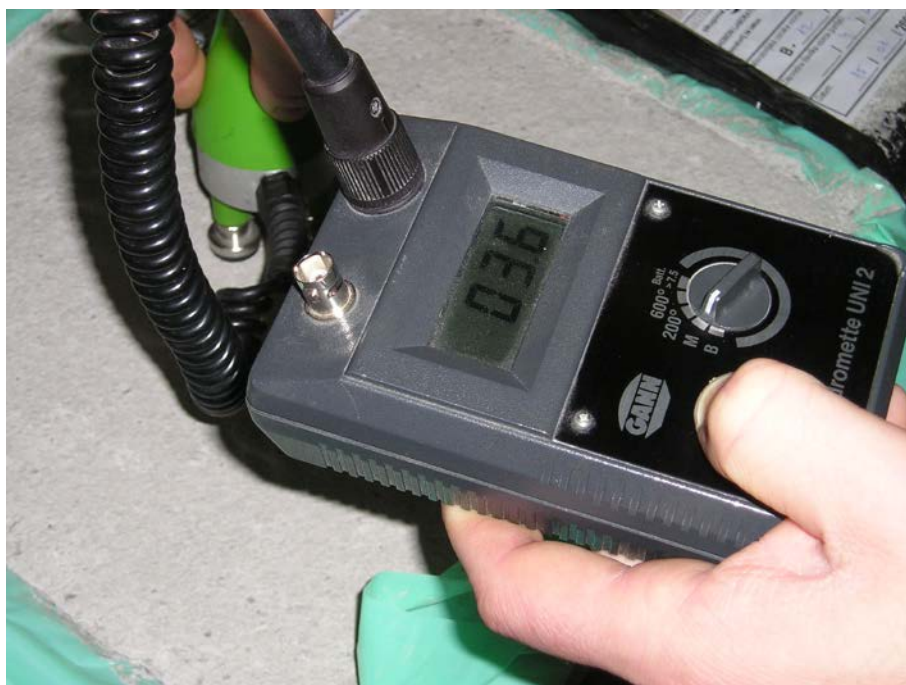
Slika 3.11: Meritev površinske vlage estriha z univerzalnim merilcem vlage
