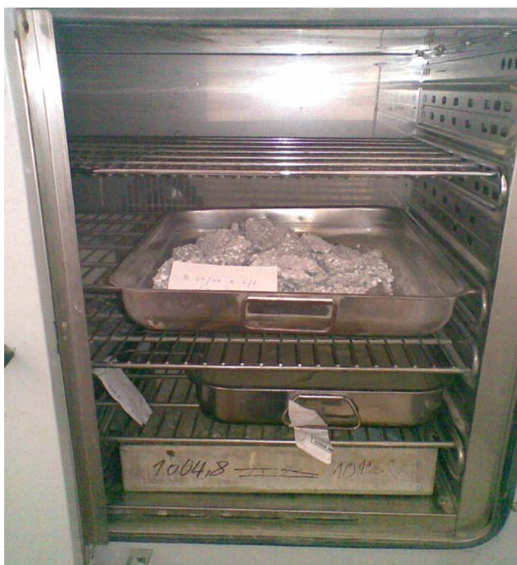
Slika 3.13: Sušenje vzorca v sušilniku
