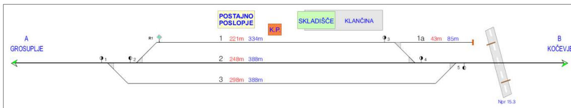
Slika 30: Tirna shema postaje Dobrepolje (Vir 30 Program omrežja Republike Slovenije za leto 2011, priloga 3.3.)
