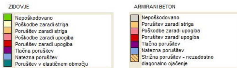
Slika 29: Barvna legenda poškodovanosti zidov (S.T.A. DATA, 2009)
