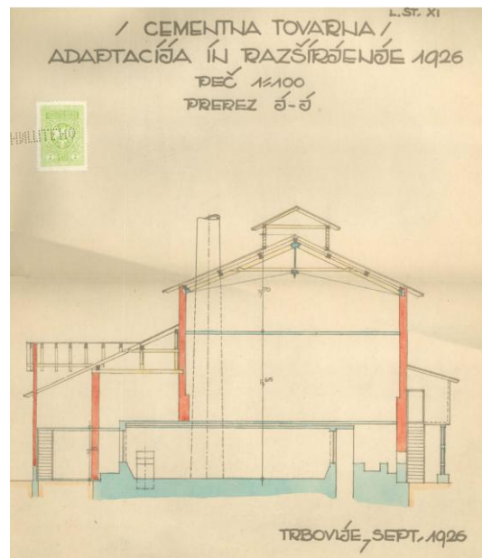
Slika 15: Peč, prerez J-J, 1926. Vir: ZAC 0013 Sresko načelstvo Laško, 1926/1927 18, Adaptacija in razširitev cementarne, A.Š. 2
