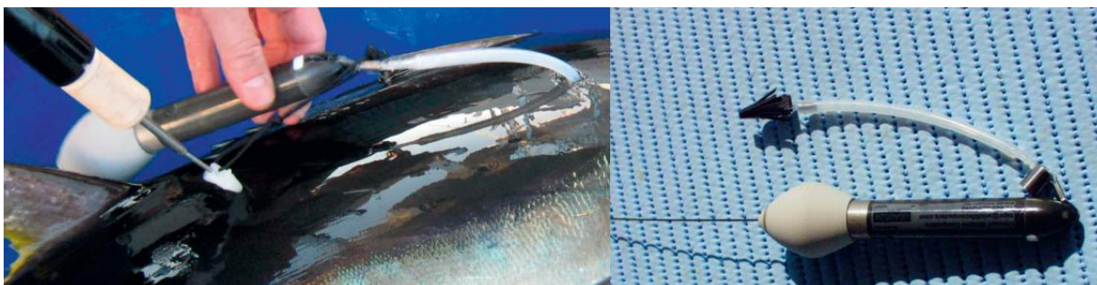
Slika 24: Uporaba satelitske telemetrije za spremljanje modroplavutega tuna (Argos Forum, 06/2008).
