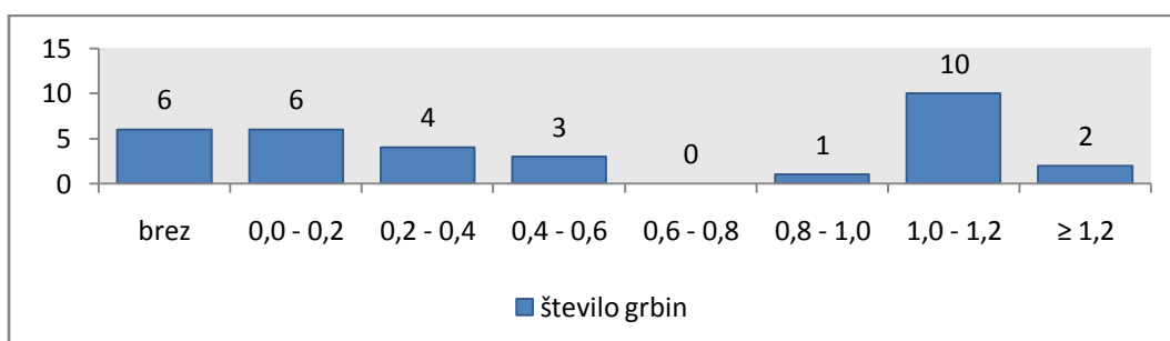
Slika 30: Odstopanje izmerjene širine grbine od predpisane širine a.
