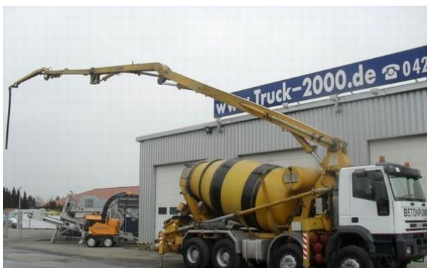
Slika 15: Avtočrpalka Iveco 410e 38 z 28m dolgim dosegom cevi za betoniranje
