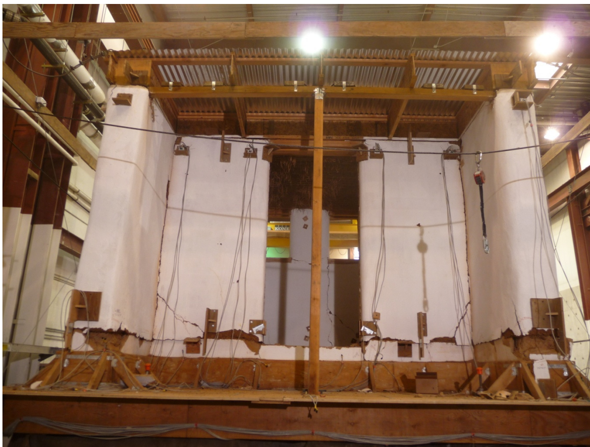
Slika 24: Simulacija potresa na samonosilni konstrukciji iz slamnatih bal, Univerza v Nevadi, 2009 (vir: http://nees.unr.edu/projects/straw_bale_house.html )
