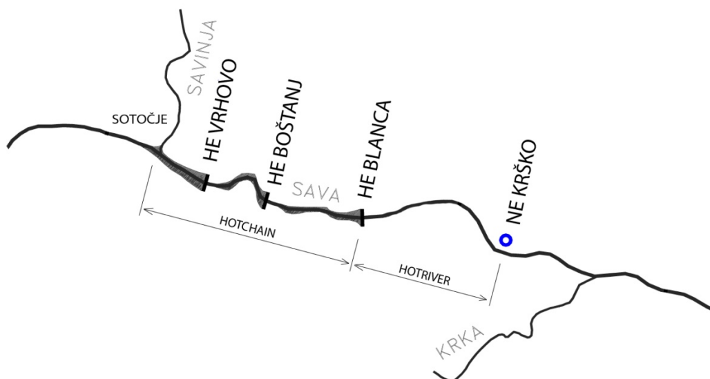
Slika 14: Shematični prikaz verige treh hidroelektrarn, kjer je bil uporabljen model HOTCHAIN ter nezajezeni del reke, kjer je bil uporabljen program HOTRIVER.
