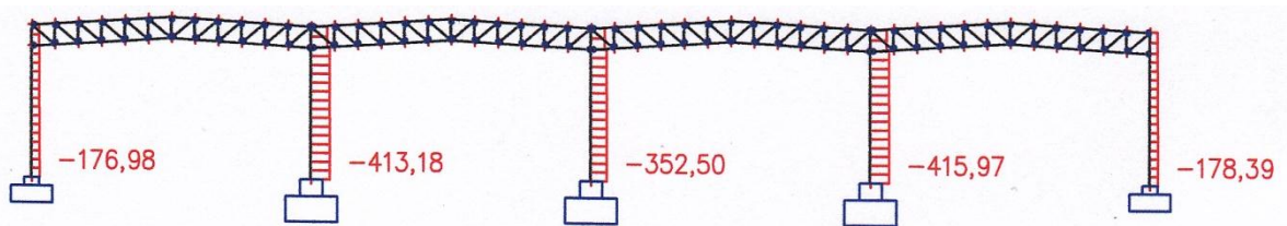
Slika 39: Osne sile v stebrih primarnega okvirja – smer X v kN
