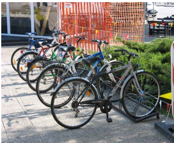
Slika 60: Neustrezna stojala, ki podpirajo samo obroč kolesa, pri železniški postaji v Kopru
