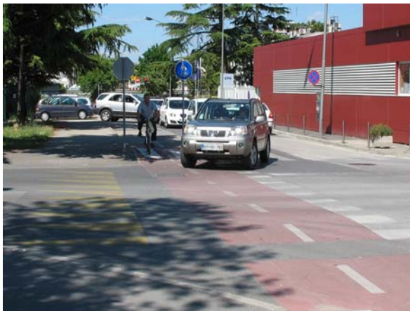
Slika 47: Avtomobil se pri čakanju na prosto pot nepravilno ustavi in zapre pot kolesarju
