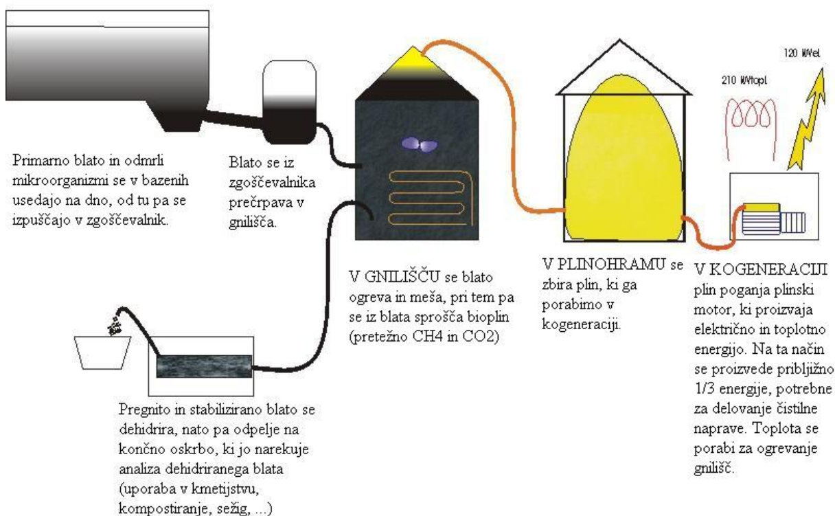
Slika 60: Shema postopka pridobivanja bioplina ( www.loska-komunala.si )
