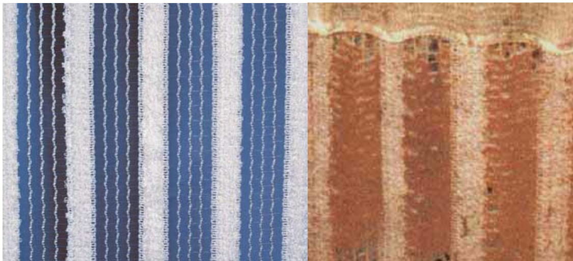
Slika 7: Cleartec ® - material za pritrditev biomase brez in s priraščeno biomaso (biofilmom) http://www.esi.info/documents/Eimco_Cleartec_ML.pdf
