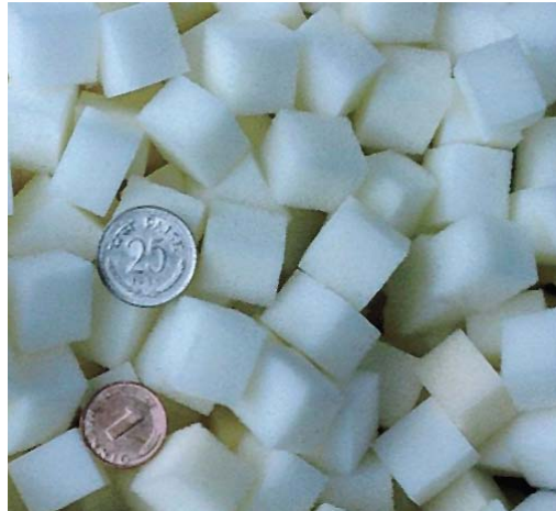
Slika 6: LINPOR ® - porozni plastično penasti nosilci (medij)
