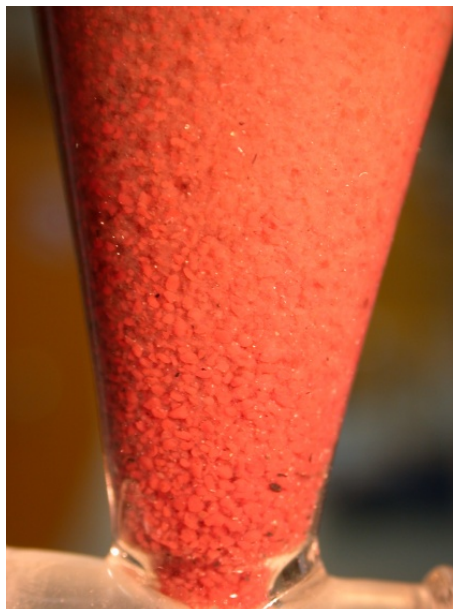
Slika 23: Granulirano aktivno blato v DEAMON procesu http://www.cyklar.ch
