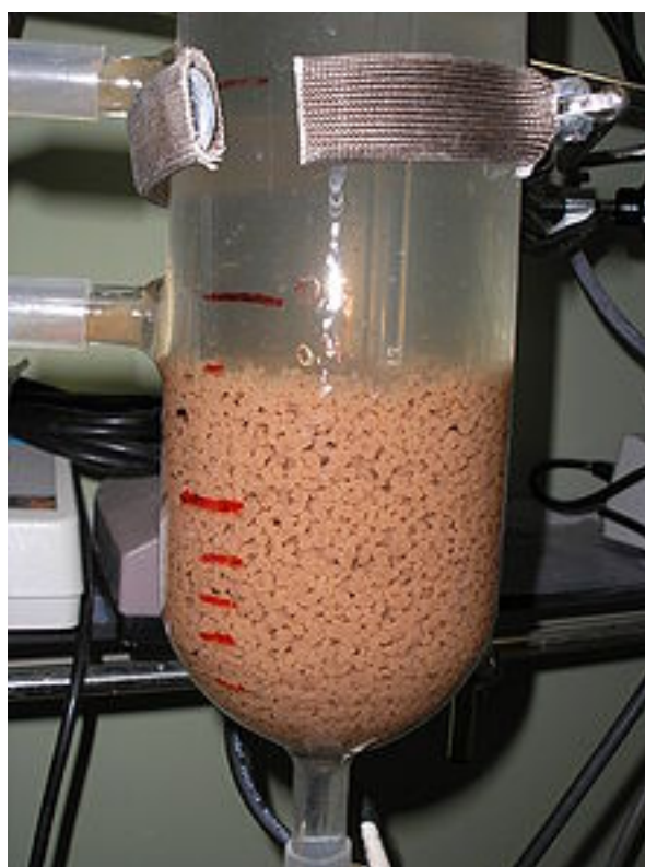
Slika 17: Pilotna naprava procesa z granuliranim aktivnim blatom in granulirano blato http://en.wikipedia.org/wiki/Aerobic_granulation
