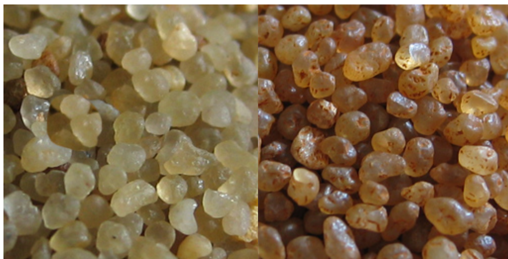
Slika 36: Silikatni pesek prevlečen z železovim hidroksidom (desno) in brez (levo).
